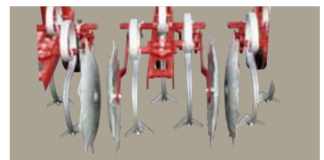
Parallellogram met 3 tanden voor rij-afstanden 45 - 55 cm.
