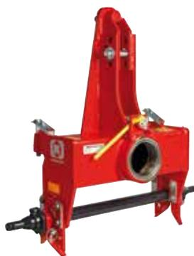
**150er Drehwerk:** Beschreibt die Dimensionierung der Hohlwelle. Für stressfreies Ackern mit Traktoren bis 220 PS. Mit Tragachse in CAT II & III erhältlich.
