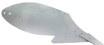
**Der Körper-Typ AH** sind grössere Universal-Körper mit guter Krümmelung und sehr guter Furchenräumung für breite Reifen. Für Schnittbreiten ab 40 cm und Arbeitstiefen bis über 30 cm.
