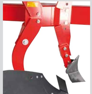
**Scherbolzen: 16 mm Schraube in der Qualität 10.9, mit einer Bruchkraft von 4000 kg.**
