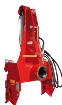
**180er Drehwerk:** Heavy Duty Drehwerk für unsere größten Anbaupflüge. Diese konische Hohlwelle (150 mm - 180 mm) wurde aus einem Stück gefertigt und wärmebehandelt.
