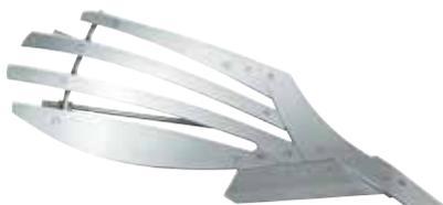
**Der Körper-Typ AS** Streifenkörper mit 4 separat austauschbaren Streifen die zweifach abgestützt sind. Für alle Bodenarten geeignet, der Einsatz überzeugt besonders in klebenden Böden. Intensive Krümmelung, perfekt gedrehte Erdbalken am Hang und die Furchenräumung für breite Reifen sind bestechend. Für Schnittbreiten ab 40 cm und Arbeitstiefen bis über 30 cm. ▶
