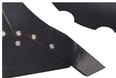
durch begünstigt, das Schar, Spitze und Streichblech auf einer Ebene liegen. Dies bedeutet, daß der Verschleiß gleichmäßiger verteilt und der Leistungsbedarf reduziert ist. Der Materialaufwand und das Risiko der Bodenanhäufungen an den Streichblechen ist geringer als bei anderen Pflügen. Kongskilde
