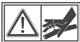
**Ne jamais essayer de déconnecter un flexible hydraulique lorsque le système est sous pression.**
