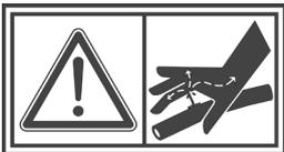
**Hydraulische Leitungen nicht trennen, wenn das System mit Druck beaufschlagt ist!**
