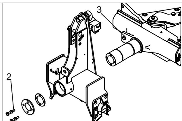
4. Entfernen Sie drei Schrauben an der Vorderfucherverstellung.
