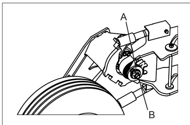
Einstellung: Den Bolzen und die Sicherungsauflage **A** entfernen und die Bremskraft durch Anzug oder Lösen der Mutter **B** einstellen. Nach erfolgter Einstellung die Sicherungsauflage anbringen. Reibscheiben dürfen nie geschmiert werden!
