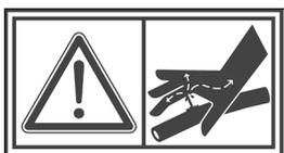
**Hydraulische Leitungen nicht trennen, wenn das System mit Druck beaufschlagt ist!**
