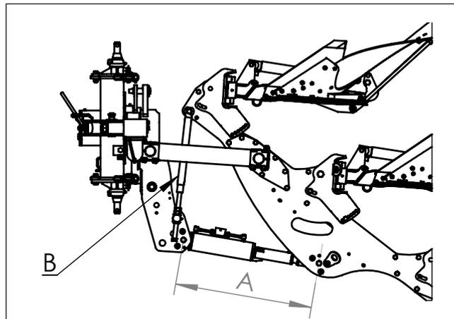
Maximale Hublänge des Ausrichtungszyllinders nachprüfen. Die maximale Hublänge des Ausrichtungszyllinders soll immer auf 1115 mm eingestellt werden.
