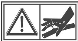
**Nunca desconecte una conexión hidráulica con el sistema sometido a presión.**
