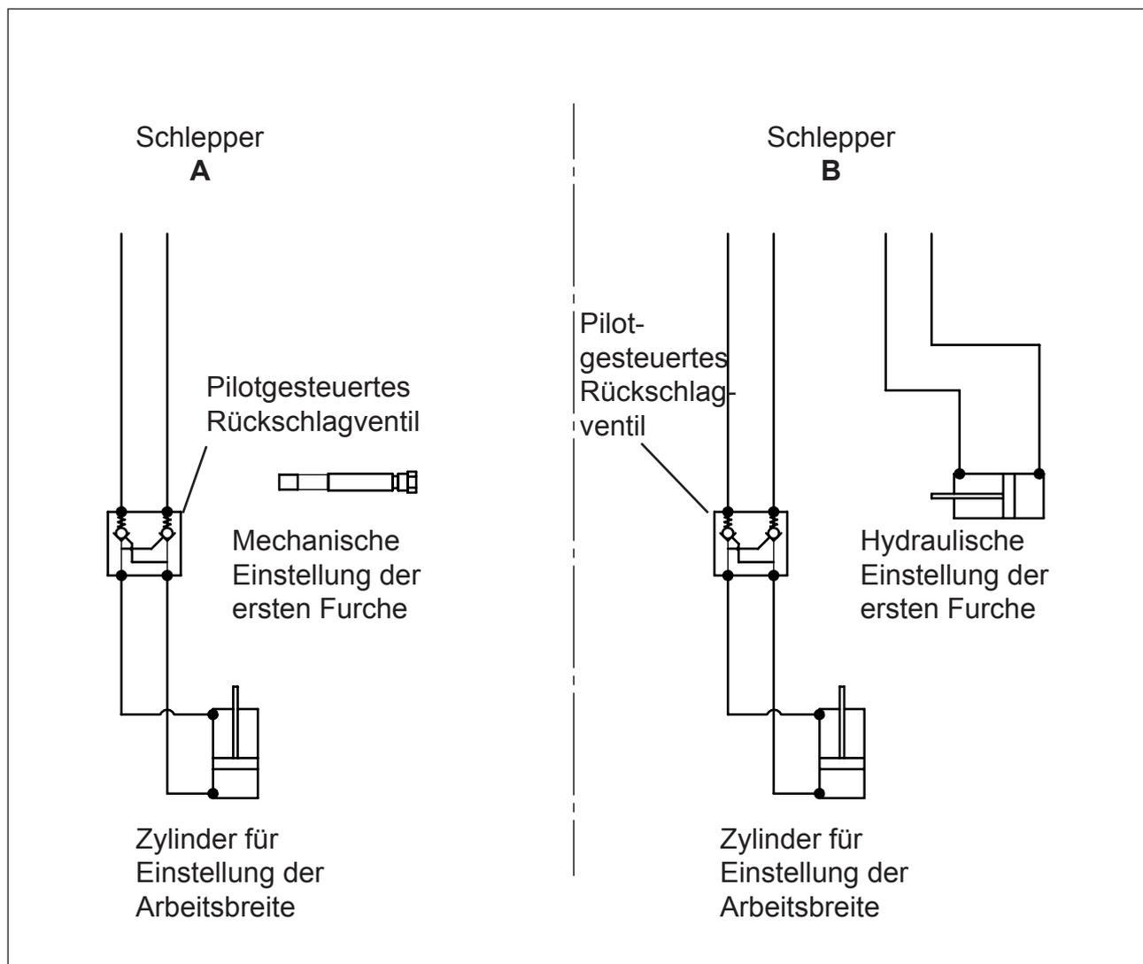
Version **A** erfordert einen doppelwirkenden hydraulischen Ausgang am Schlepper und Version **B** - zwei doppelwirkende Ausgänge.
