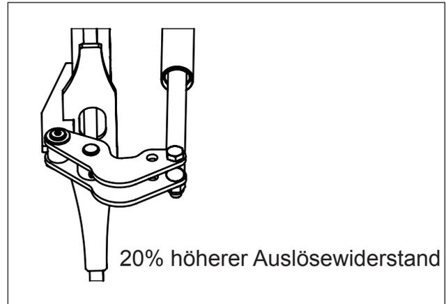
**Einstellung:** Die Versorgungsleitung des Steinsicherungssystems gemäß dem im obigen Abschnitt **REGELUNG DES BETRIEBSDRUCKES** beschriebenen Verfahren anschließen und den Druck im System kontrolliert vermindern.
