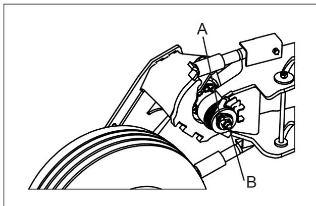
Einstellung: Den Bolzen und die Sicherungsauflage **A** entfernen und die Bremskraft durch Anzug oder Lösen der Mutter **B** einstellen. Nach erfolgter Einstellung die Sicherungsauflage anbringen. Reibscheiben dürfen nie geschmiert werden!
