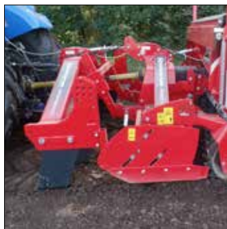
3-punktowy układ zawieszenia z wyjściem do maszyn czynnych.
