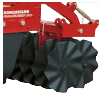
Paragrubber ECO 3000 firmy Kongskilde z wałem docinającym typu "Cutter roller".
