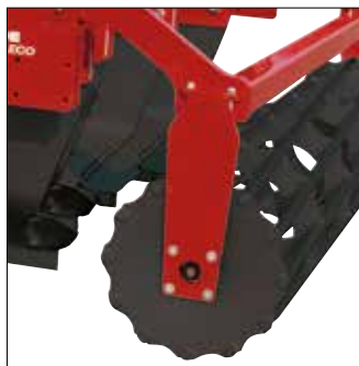
Paragrubber ECO 3000 firmy Kongskilde z wałem prętowym.
