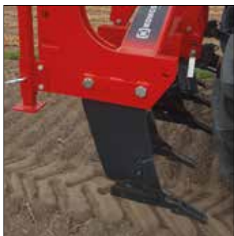
3-punktowy układ zawieszenia do maszyn czynnych.
