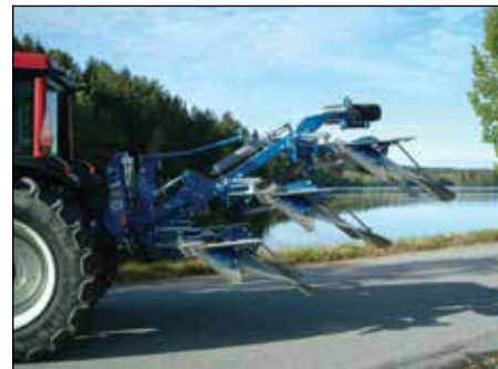
Dėl to, kad korpusai yra apverčiami po rėmu, svorio centras yra labai arti traktoriaus ir plūgą yra lengva pakelti.
