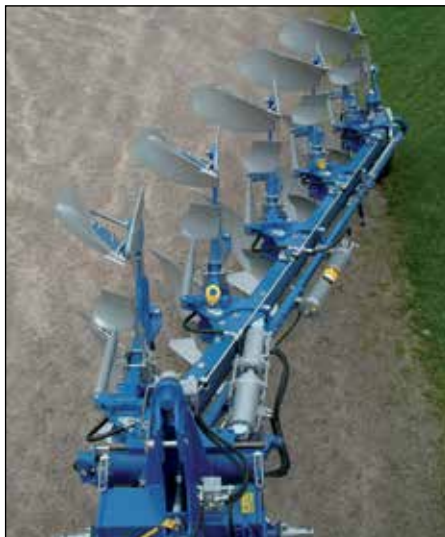
Tinkamiausia reguliavimo sistemos geometrija, leidžia reguliuoti darbinį plotį važiuojant.
