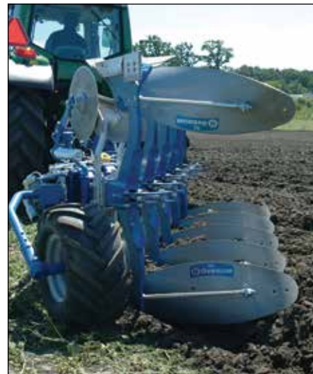
Naujas didelio našumo gylio ratas su padidintomis reguliavimo galimybėmis, turi plačią padangą su puikiais transportavimo savybėmis. Apvertimo veiksmas efektyviai sušveninamas su reguliuojamu trinties stabdžiu.
