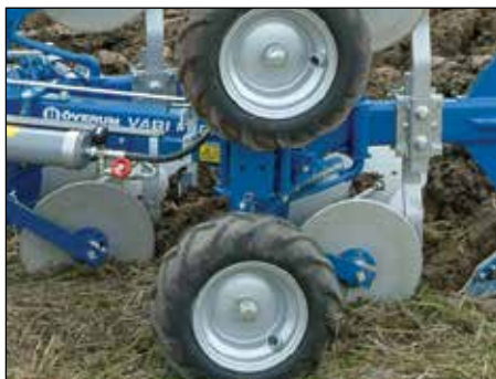
Dvigubi ratai BX, CX ir Vari Flex CX. Skersmuo 575, plotis 210 mm.
