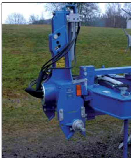
Didelio našumo priekinė dalis Cat 3, su 150/180mm centrine ašimi ir adatiniais rutuliniais guoliais, efektyviam didelių apkrovų paskirstymui. Kryžminis velenas su greita jungtimi ir galimybe reguliuoti aukštį ir ilgį. Bazinėje įrangoje yra transportavimo užraktas.
