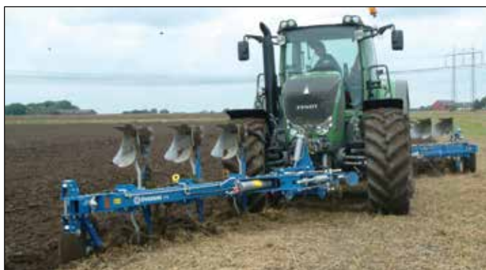
Vari Flex EX 6975 H kombinacija su priekyje kabinamu FX 31075 H plūgu, įgalina apdirbti didelį plotą, siekiantį iki 4,5 metro. Rimtas žemės įdirbimas su mažomis išlaidomis!
