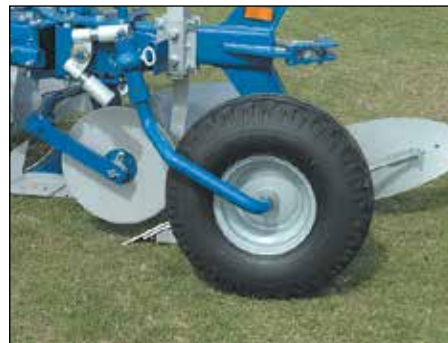
Kombi ratas gylio kontrolei/transportavimui 10.00 x 12. Skersmuo 710 mm, plotis 264 mm.
