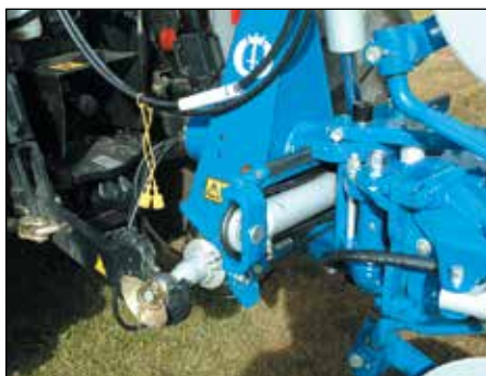
Hidraulinis šoninis suregulavimas CX/DX. Priekinės vagos plotis.
