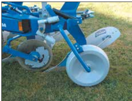
Plieninis gylio ratas. Skersmuo 500 mm, plotis 160 mm.
