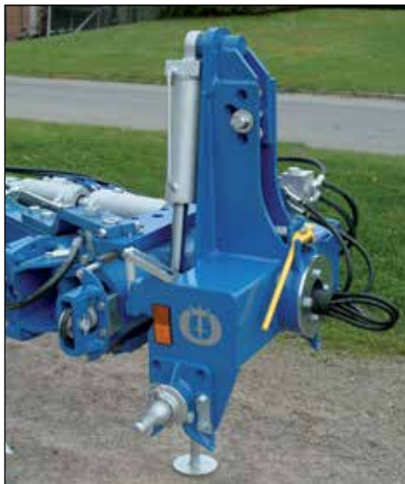
Didelio našumo priekinė dalis su 150 mm skersmens centrine ašimi ir adatiniais guoliais yra skirti traktoriams iki 200 AG.
