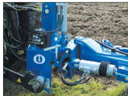
Didelio našumo priekinė dalis su greito prijungimo kryžminiu vėleniu ir sulygiavimo cilindru.
