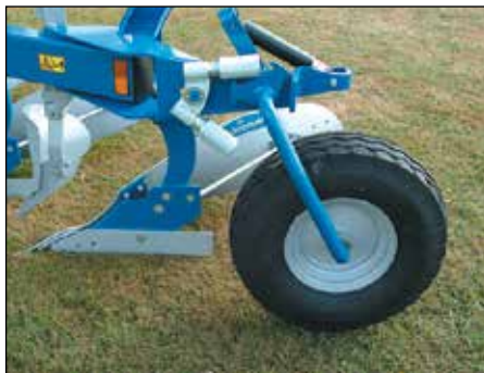
Guminis gylio ratas 7.00 x 12. Skersmuo 645 mm, plotis 182 mm.
