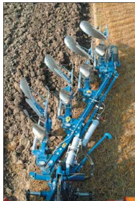
Naudojant prailginamo varžto konstrukciją, ant pagrindinio grūdinto plieno rėmo korpuso, pavyko pasiekti preciziškai tikslų arimą.
