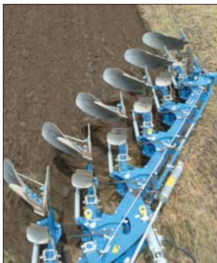
Traukimo linija gali būti sureguliuota fiksliai, o tai mažina kuro sąnaudas ir dalių dėvėjimąsi. Tvirtas pagrindinis rėmas 220x120mm be virinimo siūlių. Gylio kontrolės ratas 260/70-16, pasirinktinai 340/55-16.
