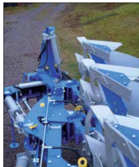
Tvirtas rėmas ir dvigubas cilindras su ilgomis atramomis, suteikia mažą apkrovą ir ilgą eksploatacijos laikotarpį. Korpuso plotis lengvai reguliuojamas net sunkiomis sąlygomis.
