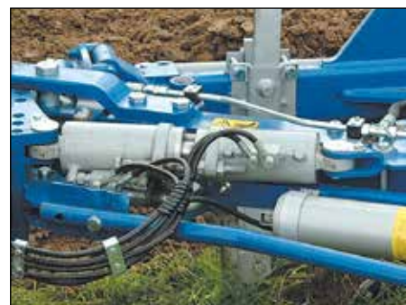
Dvigubo veikimo cilindras įsima vago pločio nustatymus, ištiesinant ir apverčiant plūgą.
