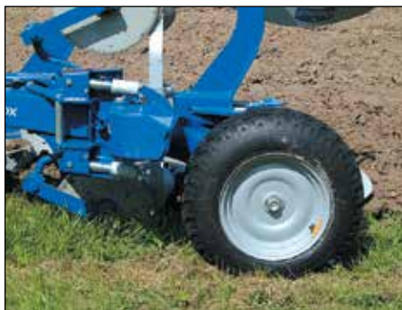
Kombi ratas Xcelsior ir Vari Flex DX modeliams. 10.5 x 16. Skersmuo 755 mm, plotis 275 mm.
