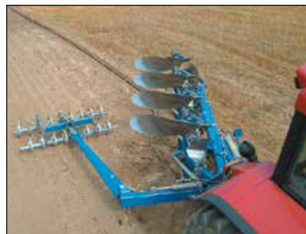
Vagy niveliavimo lygintuvas trijų ir keturių korpusų plūgams.
