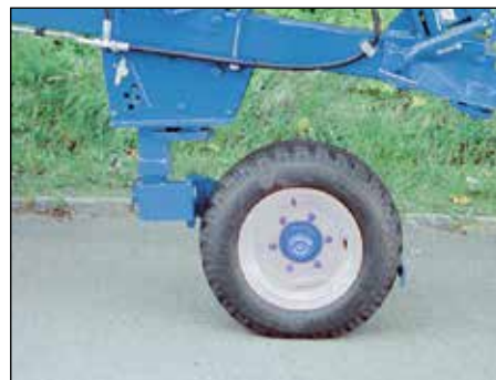
Kombi ratas priekinėje padėtyje Xcelsior DX mod. Skersmuo 755 mm, plotis 275 mm.
