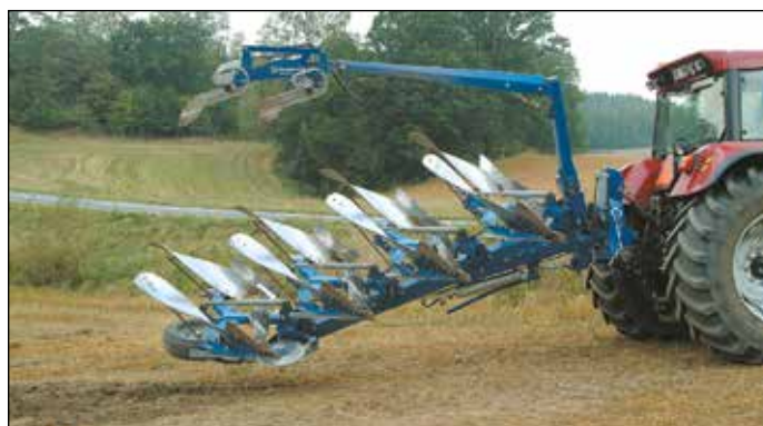
I corpi che ruotano sopra il telaio richiedono una maggiore capacità di sollevamento a differenza di quando ruotano sotto.
