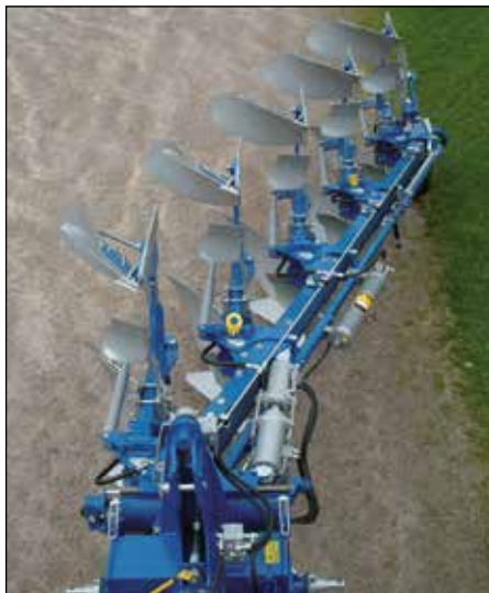
Il sistema di lavoro rende possibile regolare la larghezza di lavoro in movimento.
