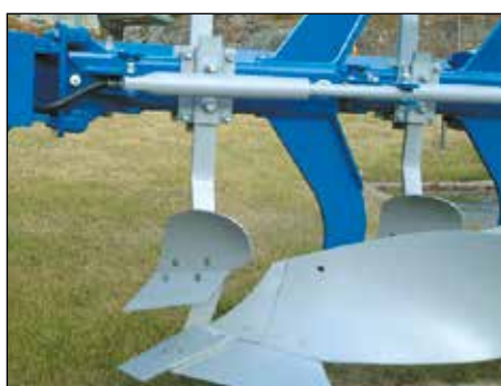
Avanvomeri EG. Taglio largo e poco profondo, lavorano bene con coltelli laterali.
