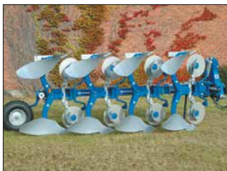
Vari Flex CX 4975 F con coltri a dischi fissi e avanvomeri EG. Sia i corpi che gli avanvomeri hanno bulloni di tranciamento.
