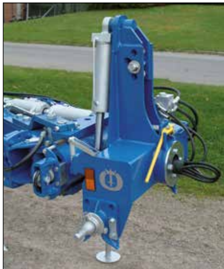
La testata ad alta resistenza con un punto di rotazione dell'albero di 150 mm e cuscinetti a rulli è progettata per trattori fino a 200 cv.
