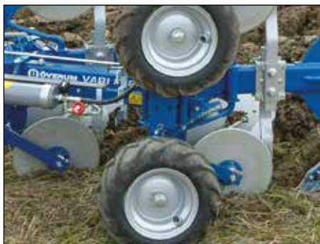
Doppia ruota per BX, CX & Vari Flex CX. Diametro 575, larghezza 210 mm.
