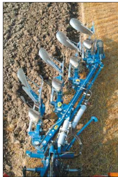
La foratura di precisione per le bullonerie passanti ha permesso l'utilizzo di acciaio trattato ad alta resistenza.
