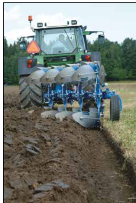
CX 4975 H, corpi XL e vomeri EG permettono di effettuare un lavoro eccellente
