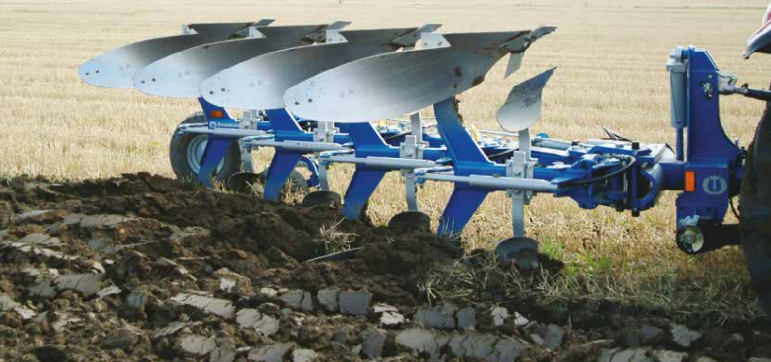
Vari Flex CX 4975 H con coltelli di taglio e vomeri tipo EG. Regolazione idraulica del primo corpo da 1,2 a 2 m.
