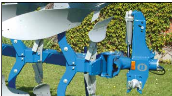
Xcelsior CX è equipaggiato con una nuova testata con attacchi rapidi.
