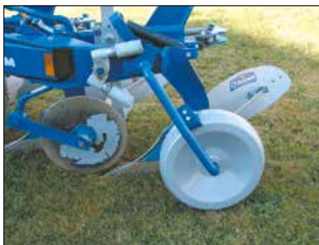
Ruota profondità in ferro. Diametro 500 mm, e larghezza 160 mm.
