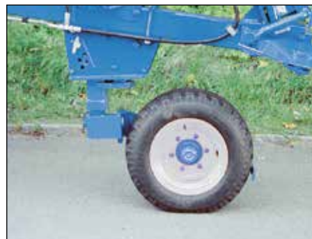
Ruota combinata lavoro-trasporto 10.00 x 12. Diametro 710 mm, larghezza 264 mm.
