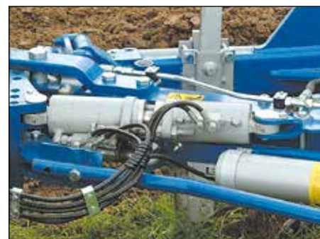
Il doppio cilindro di memoria "memorizza" la larghezza di lavoro durante l'azione di allineamento e ribaltamento.
