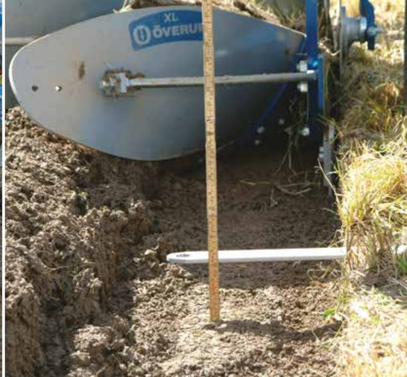
Aratura poca profonda con profondità di lavoro di 11 cm
