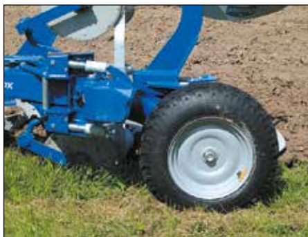
Ruota profondità gomma 7.00 x 12. Diametro 645 mm, larghezza 182 mm.
