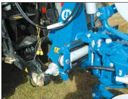
Variazione larghezza di lavoro idraulica primo corpo CX/DX.
