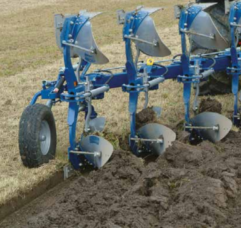
Aratura poca profonda con profondità di lavoro di 11 cm
