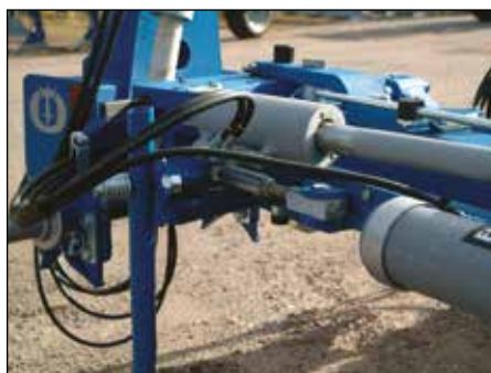
Per mezzo della vite di regolazione tutte le forze vengono bilanciate correttamente per un'ottimale richiesta di potenza.
