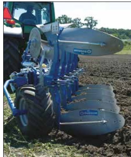
La nuova ruota di profondità ad alta resistenza a regolazione variabile garantisce le migliori condizioni di lavoro. Il movimento di ribaltamento è frenato da una frizione.
