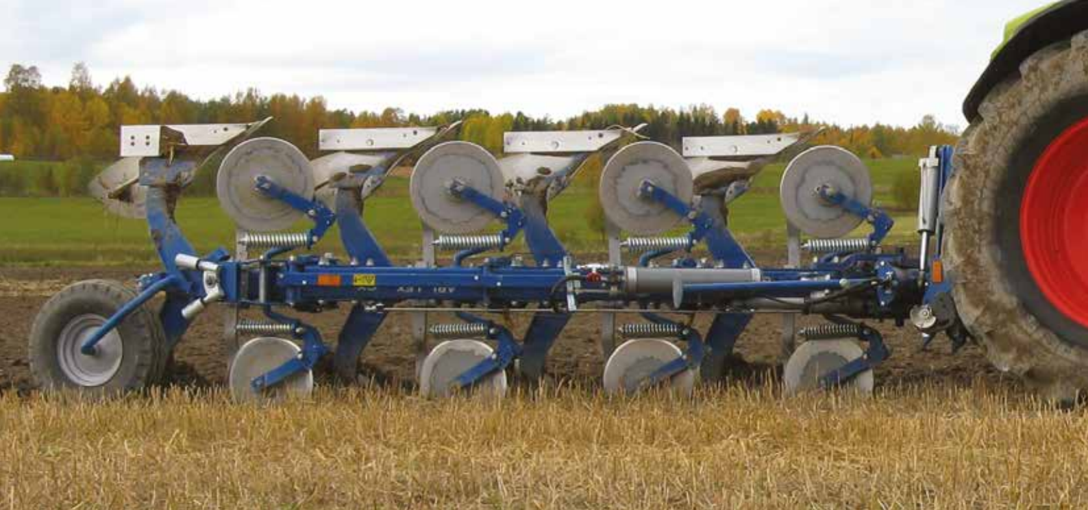
Vari Flex CX 4975 H con dischi ed avanvomeri tipo EG. Sistema di regolazione idraulica del primo corpo.
