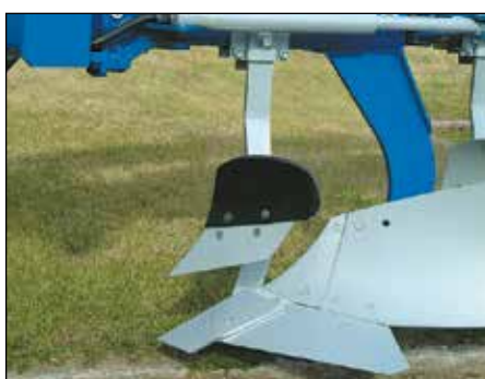
Avanvomeri EP. In plastica per terreni collosi.
