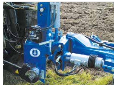
Testata ad alta resistenza con aggancio rapido e cilindro di allineamento.
