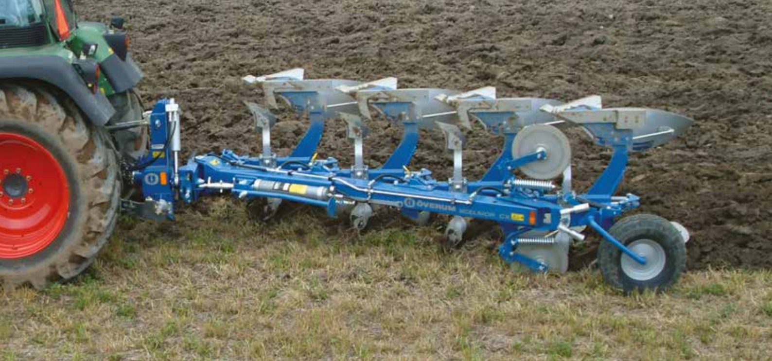
CX 4975 H con avanvomeri tipo EG. La distanza tra i corpi di 90 cm permette ai vomeri di effettuare un ottimo lavoro e girare agilmente la terra.
