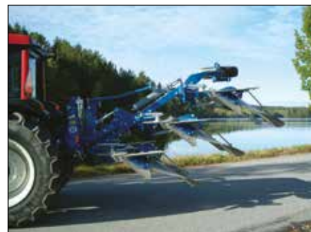
Il corpi dell'aratro ruotano sotto il telaio, il centro di gravità è vicino al trattore, e l'aratro si solleva più facilmente.
