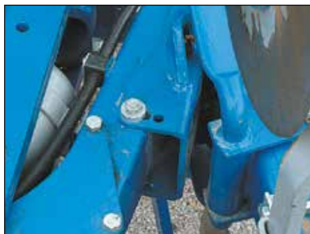
L'ampiezza del solco può essere regolata in 3 fasi.
