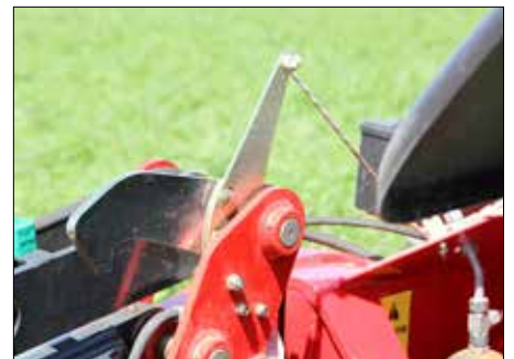
Justerbar Easy Lift: Løftecylinderen løfter nemt og hurtig maskinen fra jorden under vending på forageren.
