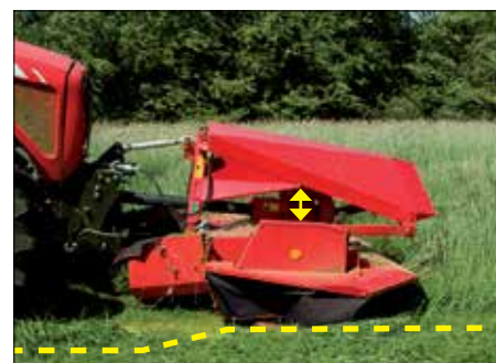
Contour Float - lodret bevægelse (ujævnt terræn)
