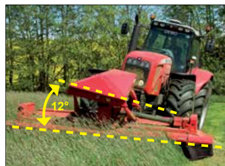
Contour Float - sideværts hældning
