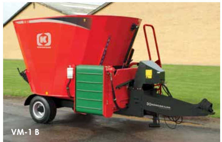
Den flexibla 4-i-en tvärbandslösningen VM-1 B X (horisontell – sidoförskjuten – uppvinklad elevator höger och vänster).
