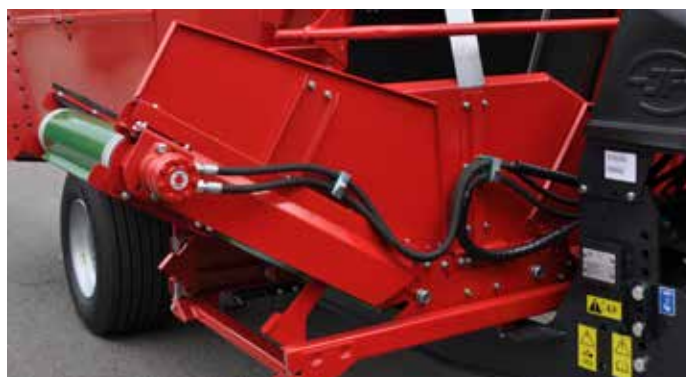
X-serien – Den flexibla 4-i-en tvärbandslösningen (horisontell – sidoförskjutet – uppinklad elevاتور höger och vänster) – VM-SB X och VM-B X.
