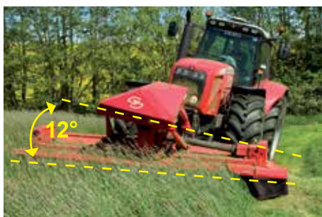
Горизонтальный угол наклона до 12^\circ
