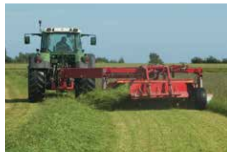
GMT L/Flex косилки могут быть оснащены дополнительным оборудованием "Collector" для сдвигания валков.
