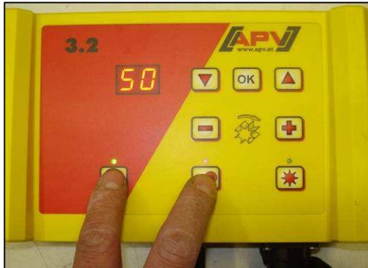
Bestätigen der eingestellten Programmierung durch Drücken der
