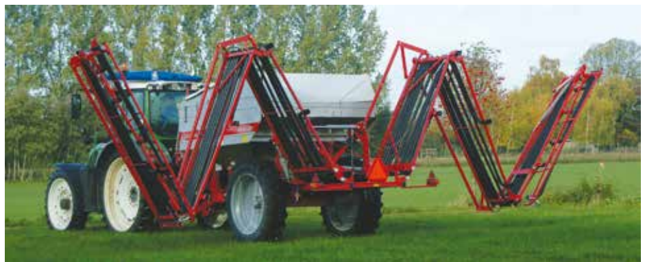
Plierea rampei se face ușor, hidraulic.
