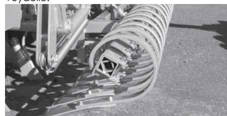
Hydraulisesti säädettävä etulata täydentää muokkausta ja tasoiittaa itämistä.
