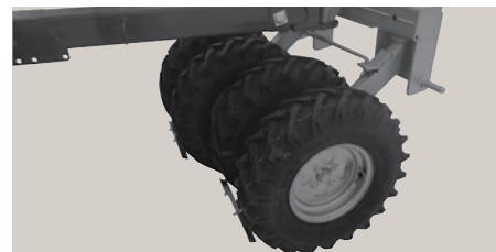
Pyöränvälilyrä tiivistää myös traktorin pyörien väliin.
