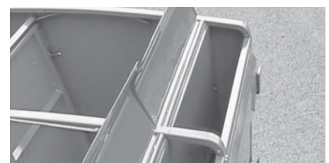
Säiliön sisälle integroitu heinäsiemenien- ja starttilannoitteen kylvölaite.
