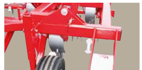
VF 4200 / 4300 / 4000 Gummirad 6,00 x 12" mit Spindeleinstellung.
