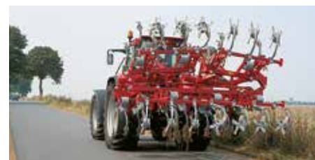
Les extensions latérales reposent sur le châssis au transport.
