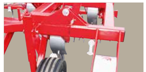
Réglage par manivelle des roues 600 x 12.
