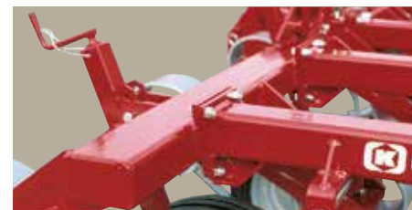
Roues pneumatiques 24 x 8.00 x 14.5.
