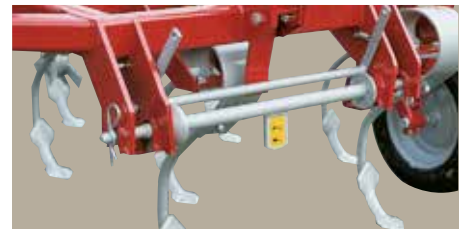
Attelage semi-automatique sur Vibro Flex gamme 2000/4000/4200/4300.
