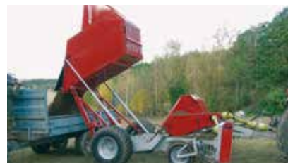
Tanken har en losse-høyde på 2,3 meter.
