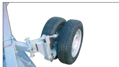
På SB 5200 styres steinrivernes arbeidsdybde av stillbare tvillinghjul.
