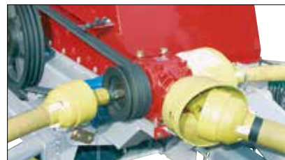
Løftetromlen drives via en girkasse og et kileremstrek.
