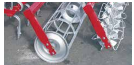
I rulli a gabbia sostengono la macchina nella sua posizione di lavoro.
