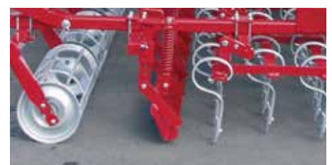
Barra livellante a molla con carico regolabile.
