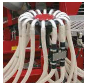
Twee verdeelkoppen achter de zaadtank hierdoor kortere slangen met minder onderling lengteverschil.
