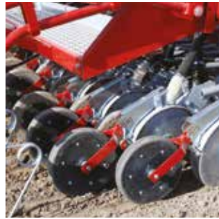
Dubbel schijfkouter (DR) met aandrukwiël (optie).
