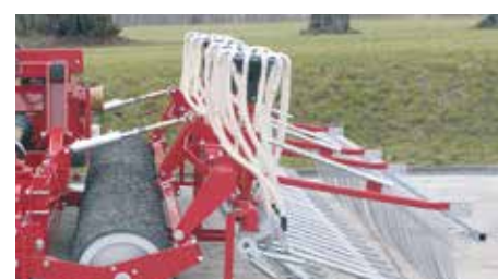
Kouterbak afgesteund op de rol.
