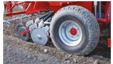
Töökindel ja täpne mõõtmisüsteemi ajam suurtelt ratastelt. (Lisavarustus).
