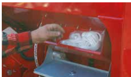
Integreeritud laegas tööriistade, varuosade vms hoiustamiseks.
