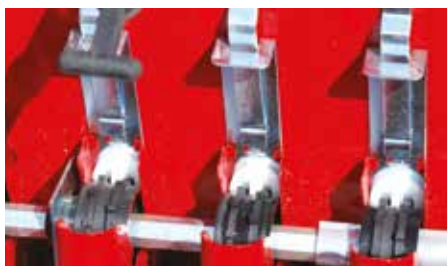
Klapid peenseemne külvinormi vähendamiseks.
