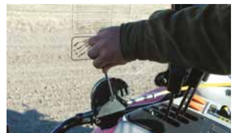
Külvinormi astmevaba kaugseadmine otse traktori kabiinist. (Lisavarustus).
