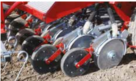
Topeltketastega ketasseemendid (DR) koos kummist rearullidega. (Lisavarustus).
