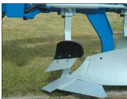
Priekšlobītājs EP. Plastmasas vērstuve labi attīrās no augsnes.
