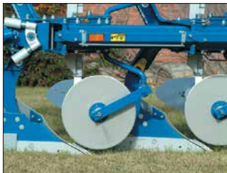
Atgriezējdisks bez aktīvas aizsardzības 18" vai 20" gluds vai 20" rievots disks.
