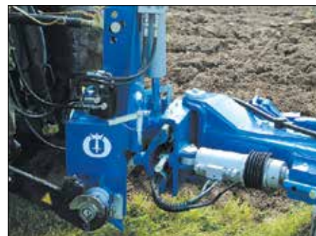
Īpaši izturīga sakabe ar ātri noņemamu šķērsstieni un sakļaušanas cilindru.
