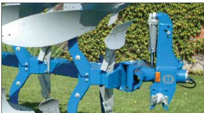
Xcelsior CX ar jaunas konstrukcijas sakabes trijstūri un ātrās sakabes asi.
