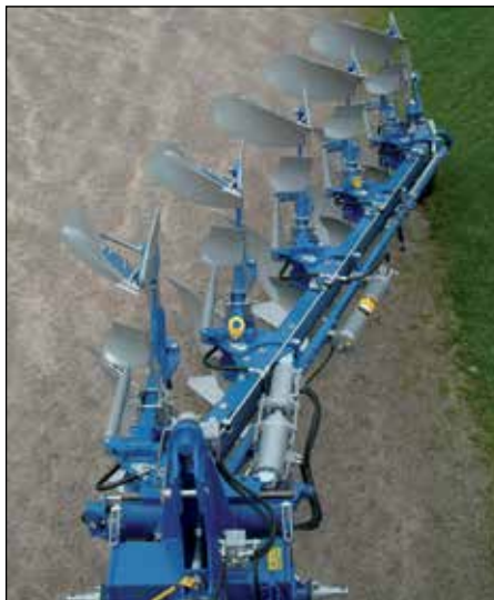
Regulēšanas sistēmas pareizā ģeometrija, ļauj ar salīdzinoši nelielu hidraulikas spiedienu regulēt darba platumu aršanas laikā.
