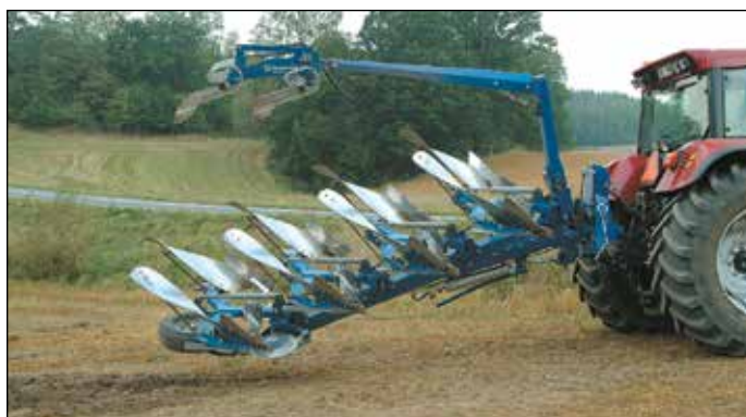
Korpusu apgriešana virs rāmja prasa nedaudz lielāku traktora uzkares sistēmas celjspēju. Ja korpusus apgriež rāmim pa apakšu (skat 3. lpp) pietiek ar mazāku celjspēju.
