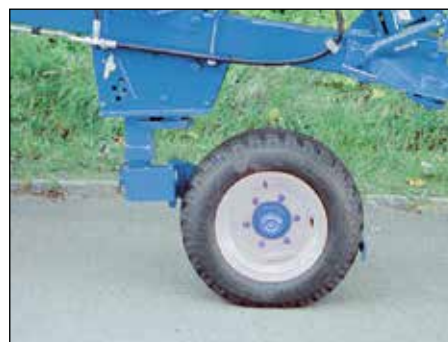
Kombi ritenis Xcelsior lzm. 10.5 x 16. Diametrs 755 mm, platums 275 mm.
