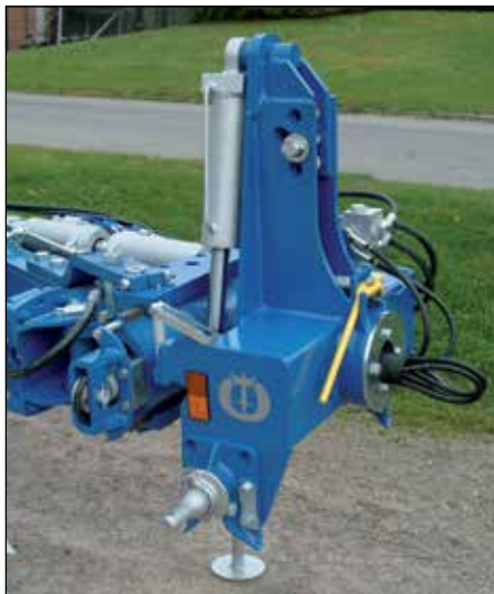
Masīvas konstrukcijas sakabe ar 150 mm apgriešanas asi un adatu gultņiem piemērota traktoriem līdz 200 Zs.
