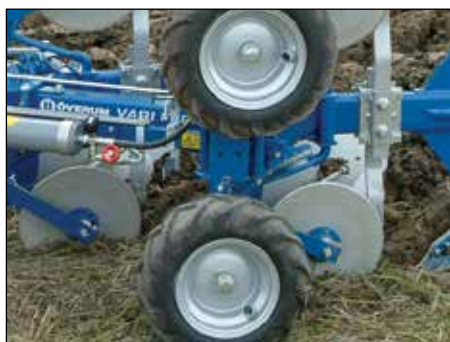
Dubultriņņi BX, CX un Vari Flex CX. Diametrs 575, platums 210 mm.
