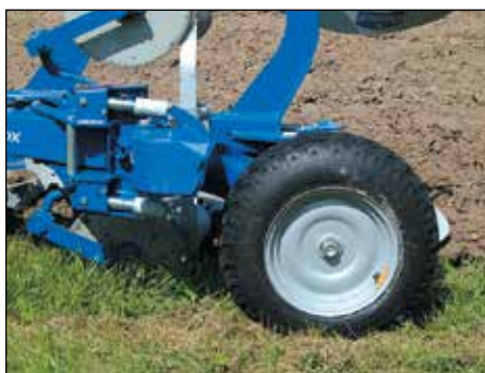
Kombi ritenis Xcelsior un Vari Flex DX modeļiem Diametrs 755 mm, platums 275 mm. DX modeļis.
