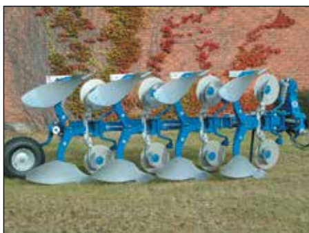
Vari Flex CX 4975 F ar fiksētiem atgriežējdiskiem un EG priekšlobītājiem. Korpusus tā pat kā korpusus aizsargā drošības skrūve.
