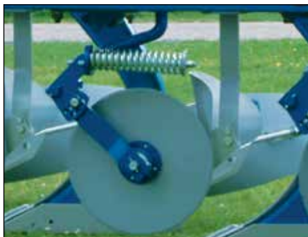
Disks ar atsperes aizsardzību 20" gluds vai 20" rievots disks.
