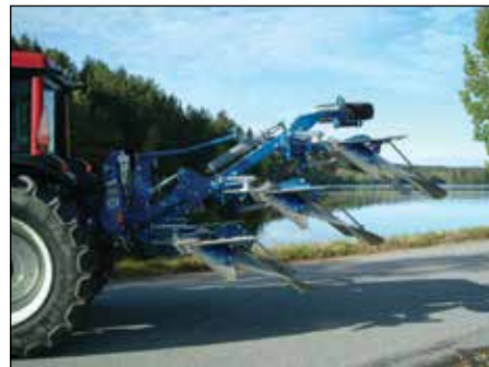
Arklu ir viegli pacelt. Pateicoties tam, ka korpusi tiek apgriezti zem rāmja, smaguma centrs pārvietojies tuvāk traktoram.
