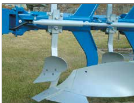
Priekšlobītājs EG. Augsni atgriež plati un sekli. Vienlīdz labi strādā ar atgriezējnazi un disku.
