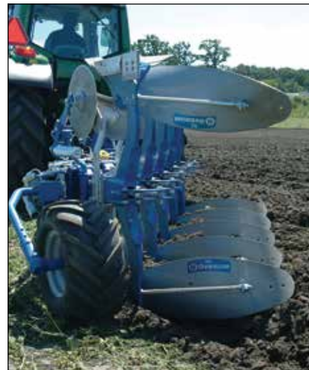
Jaunas konstrukcijas dziļuma regulēšanas ritenis ir ar platu riepu un lielāku regulēšanas diapazonu un paaugstinātu celtspēju. Lai riteni efektīgi sabremzētu apgriešanas laikā – bremzes spēku var regulēt.
