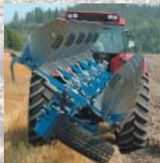
Automatické stažení záběru na minimální hodnotu zaručuje bezproblémové obrácení. Po obrácení se opět nastaví původní záběr.
