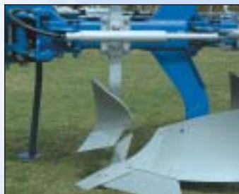
Předradlička EM. Pro velké množství posklizňových zbytků. Dobře pracuje také v kombinaci s nožovým krojidlem.
