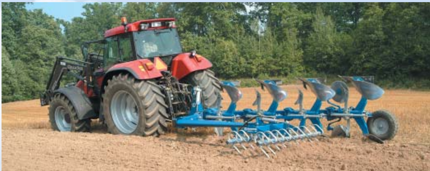
CX 490 H s integrovaným kultivátorem Nivell. Orba a kultivace v jedné pracovní operaci.
