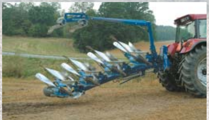
Při horním obracení, kdy se orební tělesa otáčí nad rámem, je potřeba vyšší zvedací síla než při spodním otáčení (viz strana 3).
