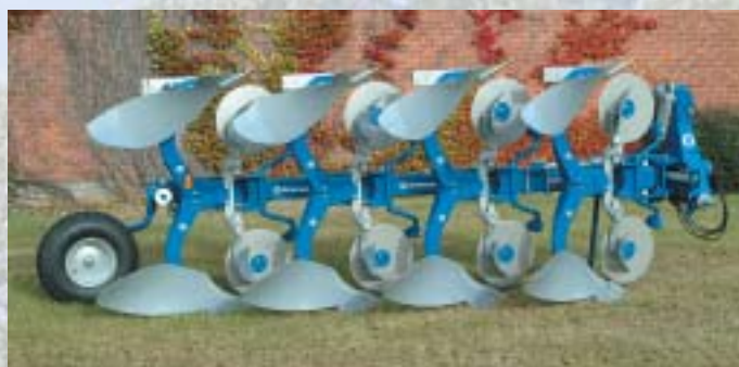
Vari Flex CX 490 F s kotoučovými krojídly a předradličkami EG. Orební tělesa a předradličky jsou jištěny střížným šroubem.
