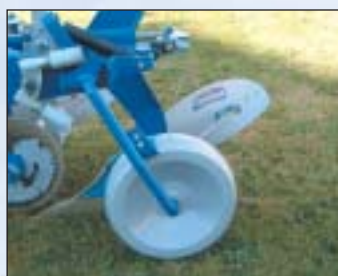
Kyvné ocelové opěrné kolo. Průměr 500 mm, šířka 160 mm.
