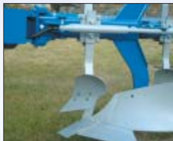
Předradlička EG vhodná na zelenou hmotu. Dobře pracuje v kombinaci s nožovým nebo kotoučovým krojidlem.
