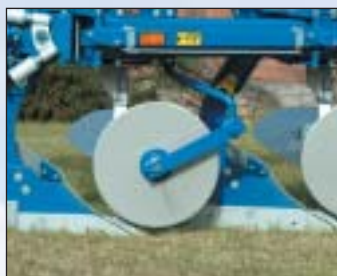
Pevné kotoučové krojidlo. Průměr 450 nebo 500 mm hladké nebo 500 mm zvlněné
