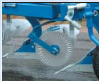
Odpružené kotoučové krojidlo. Průměr 450 nebo 500 mm hladké nebo 500 mm zvlněné.
