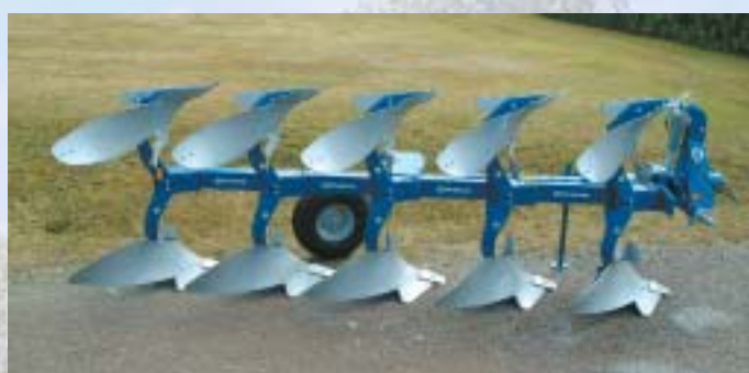
CX 590 F se zaklápěči rostlinných zbytků a boční montáží kombi kola.
