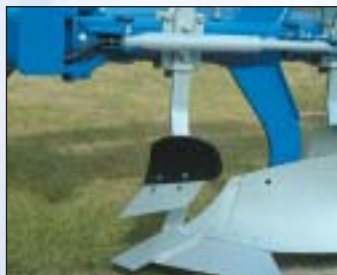
Předradlička EP s umělohmotnou odhrnovačkou vhodnou do velmi lepkavých půd.
