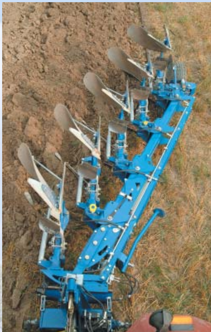
Těžiště leží blízko u traktoru, čímž je redukována zvedací síla.
