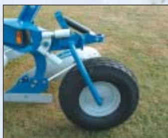
Kyvné opěrné kolo s pneu 7,00 x 12. Průměr 645 mm, šířka 182 mm.
