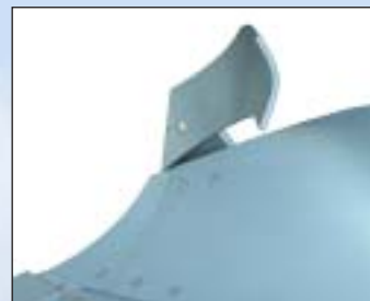
Zaklápěč rostlinných zbytků. Dobře zakládá slámu, není vhodný do lepkavých půd.
