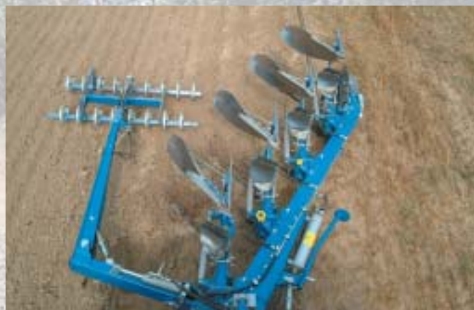
Profil rámu se v přední části rozšiřuje, protože zde se působící síly sčítají. Pracovní záběr lze nastavit ve 3 stupních.
