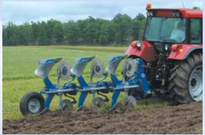
BX 380 H s orebními tělesy XL, odpruženými krojídly a předradličkami EG.
