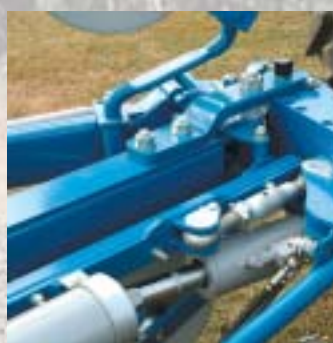
Pohybovým šroubem lze nastavit ideální tahovou linii, aby byly eliminovány všechny boční síly.
