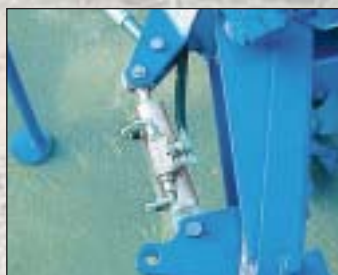
Hydraulické nastavení záběru 1.orebního tělesa u řady BX.
