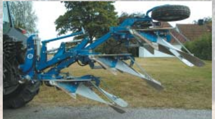
Tím, že se orební tělesa otáčejí pod rámem pluhu, je těžiště blíže k traktoru, a k otočení pluhu stačí menší zvedací síla.
