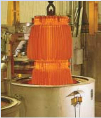
Cementování polotovarů radlic.
