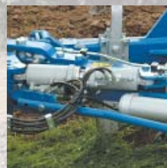
Dvojitý hydraulický válec pro podélné vyrovnání.
