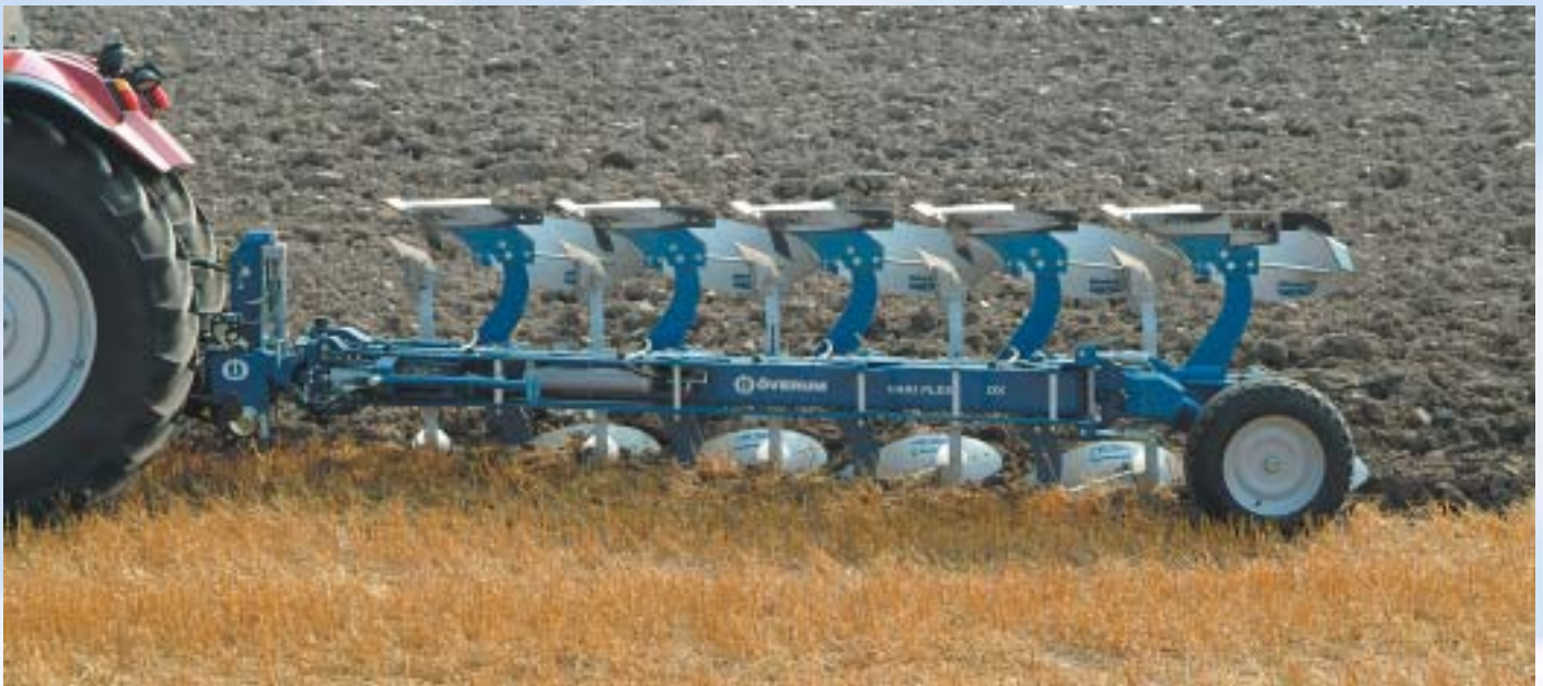
Vari Flex DX 590 H. Výkonný pluh s hydraulicky měnitelnou šířkou záběru.
