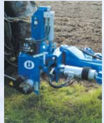
Závěs 3. kategorie, otočná osa o průměru 150 mm, rychlozávěs a válec podélného vyrovnání.
