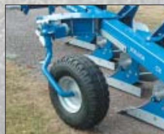
Kombi kolo předsazené do předu. Průměr 710 mm, šířka 264 mm.
