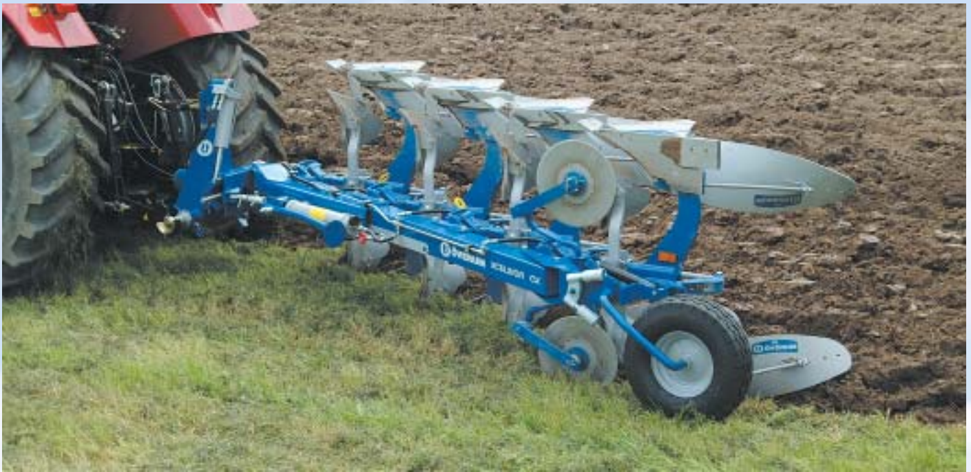
CX 490 H s předradličkami EM. Vzdálenost orebních těles 90 nebo 100 cm zaručuje dostatečný prostor pro efektivní práci předradliček.
