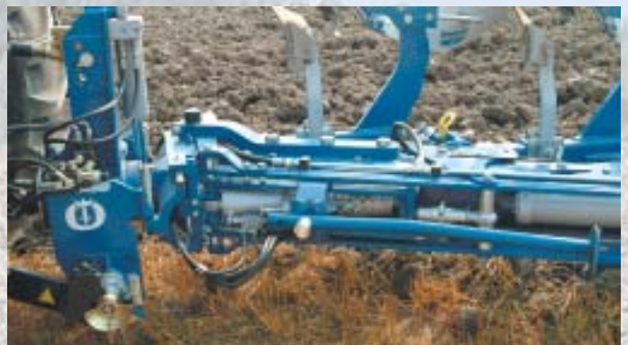
Dvojitý hydraulický válec podélného vyrovnání registruje nastavený záběr. Tahovou linií lze mechanicky nastavit tak, že boční síly jsou eliminovány a pluh je lehce tažitelný.
