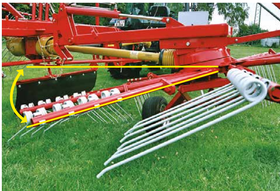
Rotor à suspension balancier, permettant un excellent suivi du sol.
