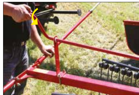
Réglage simple de la hauteur de travail, grâce à une manivelle.
