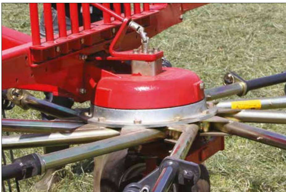
Bevægeligt rotorophæng - Rotorerne kan frit pendle til siden og dermed tilpasse sig terrænet.
