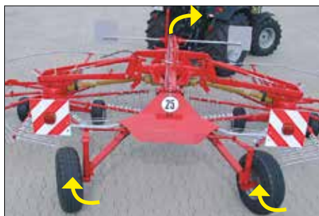
Bevægeligt rotorophæng - Rotorerne kan frit pendle til siden og dermed tilpasse sig terrænet.
