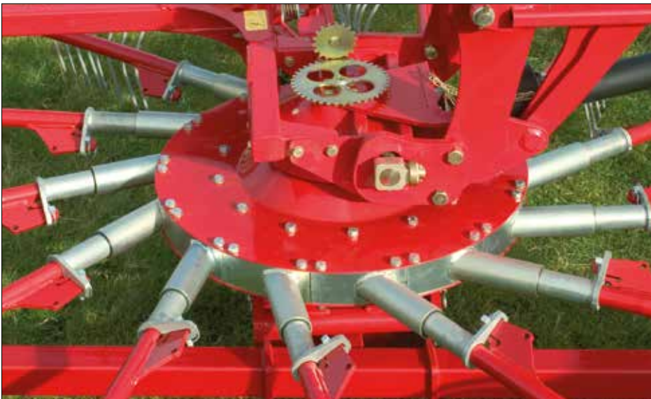
Rotorene på Pro-serien har en stor lejeafstand.
