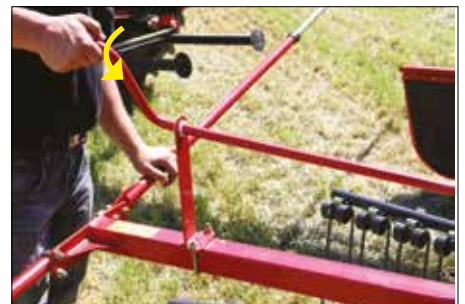
Arbejdsdybden indstilles bekvemt med en spindel.
