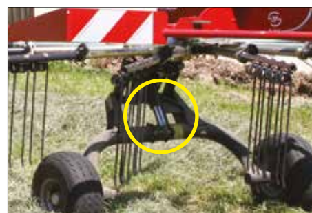
R+ 1410 SB med automatisk styring til skarpe sving. Det bedste resultat opnåes med to overlappende rotorer.
