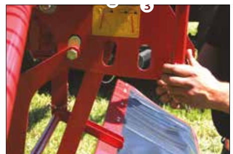
Alle midterskårsriver har variabel arbejdsbredde. På R+ 760 kan man fjerne skårdugen og bruge hullet til at opnå en endnu smallere arbejdsbredde. Dette kan være relevant ved arbejde i lucerne.
