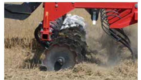
Vordere Schneidscheibenreihe am Vibro Flex 7400.
