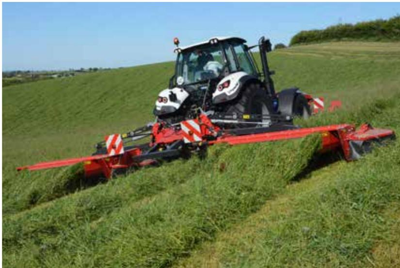
Mit der GXS-Triple-Mähwerkskombination kann die Kapazität zusätzlich erhöht werden. Eine GXS 9005/9005 P Triple-Mähwerk kombiniert mit einem Frontmähwerk hat eine Arbeitsbreite von 8,60 Meter und einer Kapazität von bis zu 15 Ha/h.
