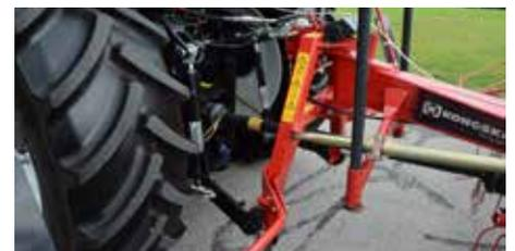
3-Punkt-Gelenkbock mit Gelenkverbindung.
