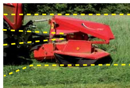
Contour Float - ständig parallel zum Boden.
