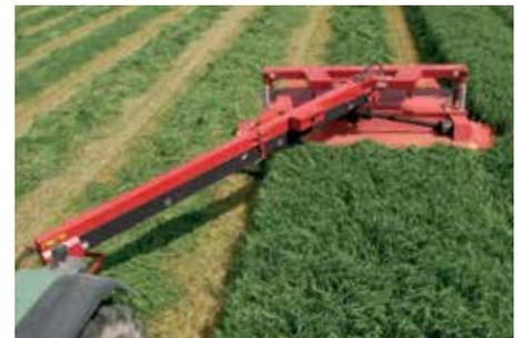
Die Flex-Maschinen sind mit einer langen, kräftigen, mittelmontierten Zugdeichsel ausgerüstet.
