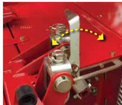
Breitstreuen - Top Dry - wird mit einem praktischen Hebel aktiviert – ohne Werkzeug! Mit dem Hebel wird ein Blech hinter dem Aufbereiter heruntergeklappt. Damit wird das Gras länger aufbereitet, breitgestreut und trocknet besonders schnell.
