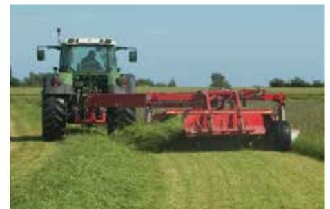
Die GMT L / Flex Mähwerke können mit dem Collector für Schwadzusammenlegung ausgestattet werden. So können Doppelschwaden für die nachfolgende Maschine abgelegt werden - zur Optimierung der Maschinenkette.
