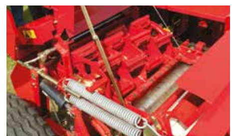
Einfacher Service-Zugang des Häckslerrotors, den Auswurfkrümmer einfach herunterkippen.
