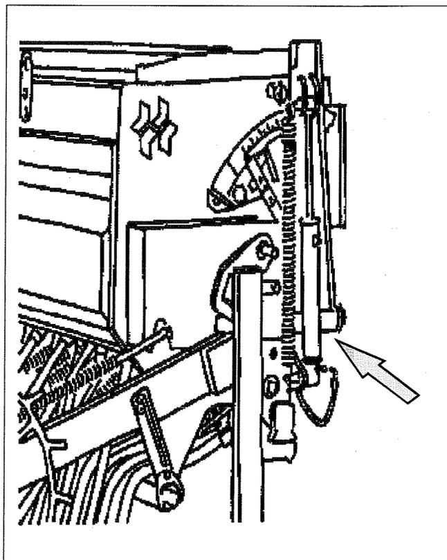
Abb. 5C. Schmierstellen der Maschine.
