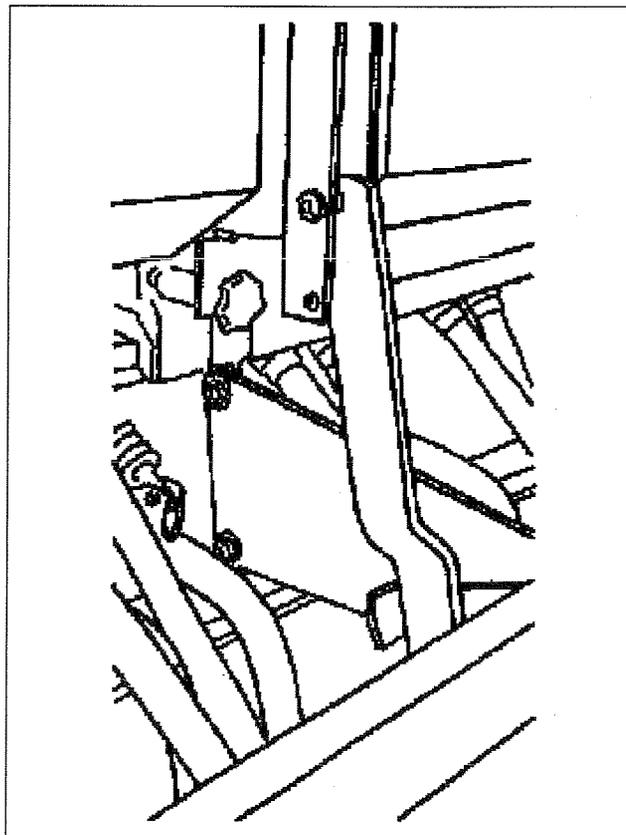
Abb. 2K Montierung der Nachegge.
