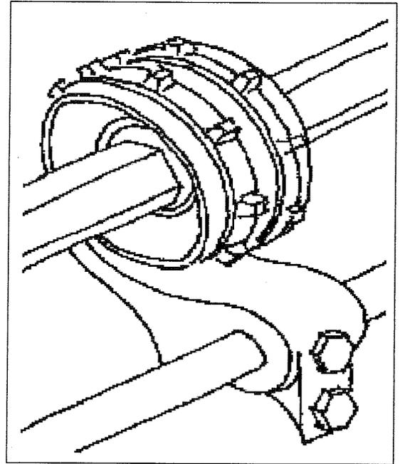
Abb. 5B. Schraube zur Justierung der Bodenklappen.
