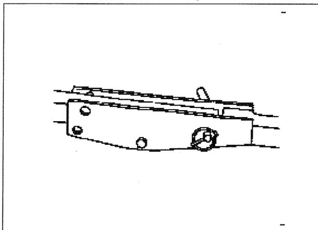
Abb. 2J. Spuranzeigerarm in Ruhestellung.
