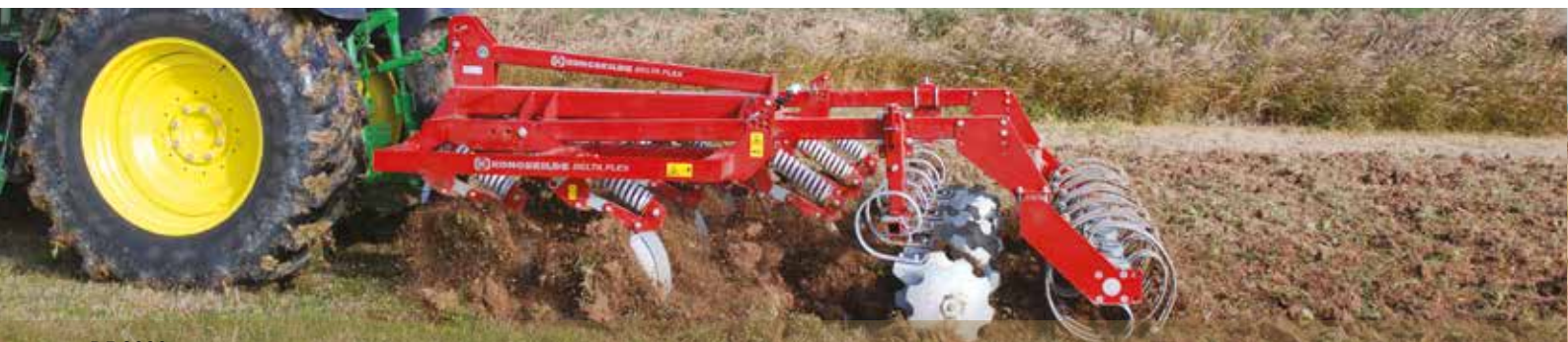
25 cm frigång vid stenutlösning.
