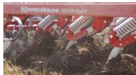
Optimal inblandning av växtrester.
