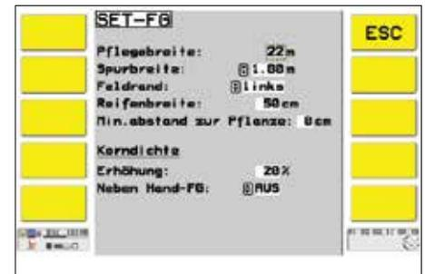
Fahrgassenmenü – Einstellung der Fahrgassenparameter.
