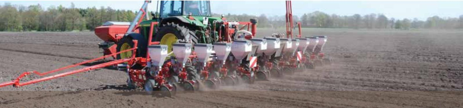
Die Becker Aeromat „E-Motion“ ist eine Einzelkornsämaschine der neuesten Generation mit elektrisch angetriebenen Säaggregaten, wodurch die Becker Aeromat „E-Motion“ dem Anforderungsprofil professionellen Lohnunternehmern gerecht wird.
