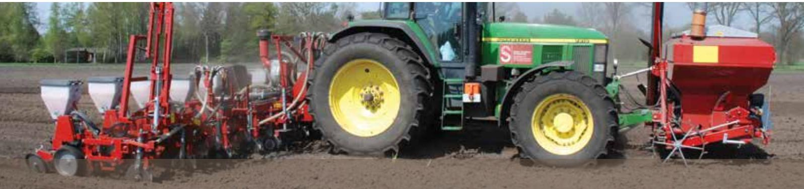
Der Aeromat „E-Motion“ beinhaltet eine komplette elektronische Ausstattung der Maschine, inklusive Kornüberwachung mittels Optogeber.
