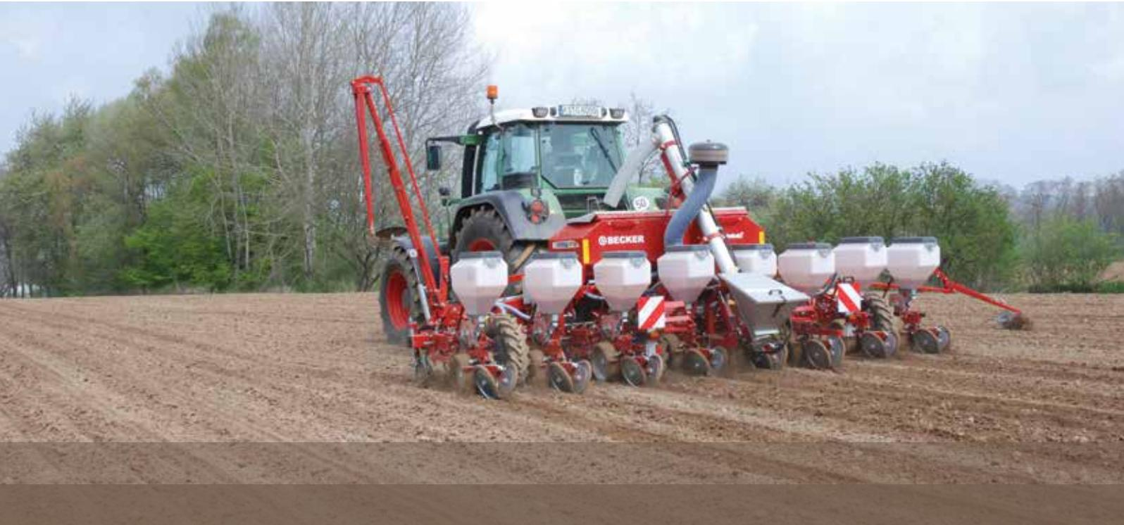
Bereits 1972 wurde bei Becker in Oberweser das pneumatische Druckluftspülsystem entwickelt und weltweit patentiert. Damit war auf dem Gebiet der Einzelkornsämaschinen eine bahnbrechende Erfindung gelungen. Seit dieser Zeit bauen wir die Einzelkornsämaschine „Aeromat“ zur Aussaat von Mais, die von Beginn an kalibrierungsunabhängig arbeitet und sich daher durch einfache Handhabung auszeichnet.
