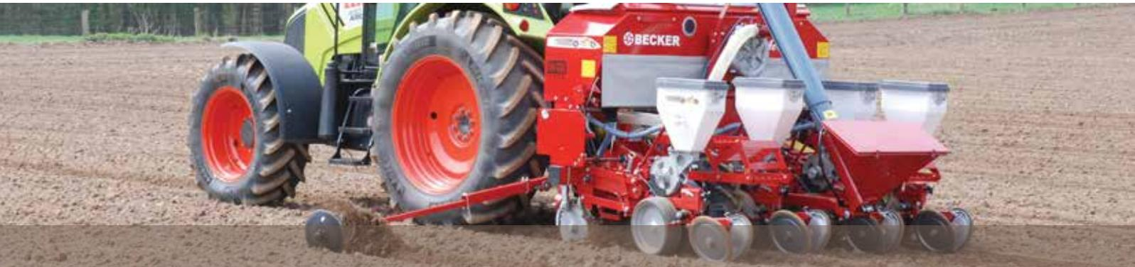
Ab Werk mit Reihendüngerstreuer zur Unterfußdüngung ausgerüstet, bilden die Modelle der „Farm-Line“ - Familie das mittlere Segment der Einzelkornsämaschinen aus Oberweser.
