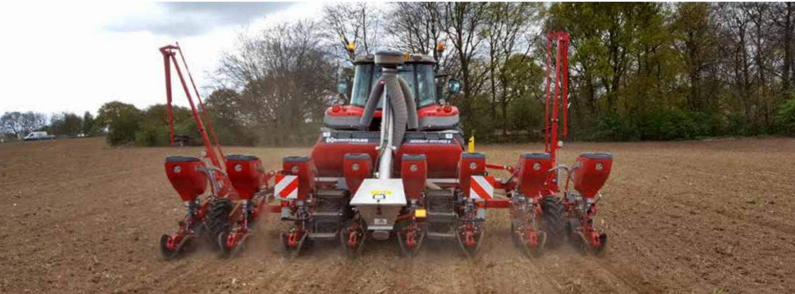
Bereits 1972 wurde bei Becker in Oberweser das pneumatische Druckluftspülsystem entwickelt und weltweit patentiert. Damit war auf dem Gebiet der Einzelkornsätechnik eine bahnbrechende Erfindung gelungen. Seit dieser Zeit bauen wir die Einzelkornsämaschine „Aeromat“ zur Aussaat von Mais, Bohnen und Sonnenblumen, die von Beginn an kalibrierungsunabhängig arbeitet und sich daher durch einfache Handhabung auszeichnet.
