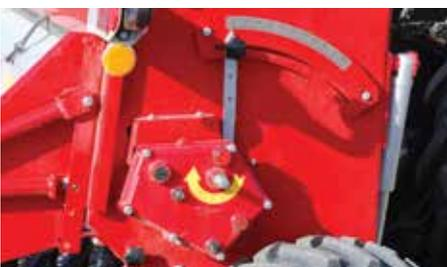
Безступенчатая регулировка дозирования высева через редуктор Vario-K.
