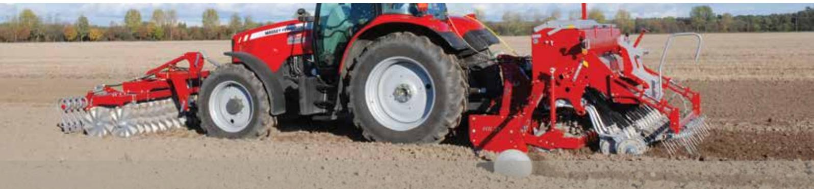
Сеялки принадлежащие серии MasterLine идеально подходят для использования в сочетании с машинами предназначенными для предпосевной обработки почвы. Модели этой серии доступны с рабочей шириной 3 и 4 метра, а также с бункером семян емкостью превышающей 1000л (модель о рабочей ширине 4 м), это делает их особенно производительными и гарантирует их высокую стабильность. Расстояние междурядий возможно: 10, 12, 13, 14 и 16 см.
