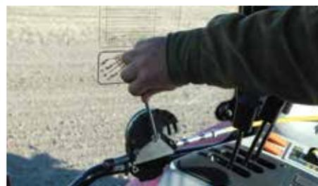
Безступенчатая регулировка дозы высева непосредственно из кабины трактора.
