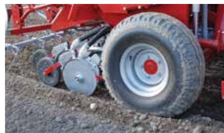
Точная и надежная система дозирования семян с приводом от больших колес.
