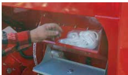
Встроенный ящик для хранения инструментов делает возможным хранение мелких предметов оборудования сеялки, запасных частей итд.
