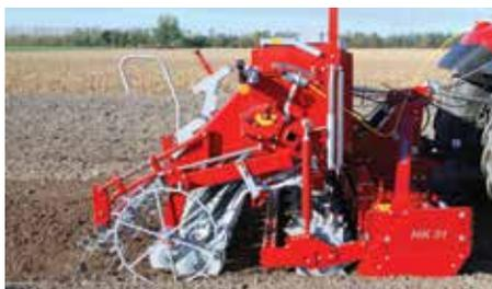
Тяжесть сеялки переносится на уплотняющий вал культиватора.
