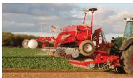
Гидросистема навески делает возможным навеску сеялки на культиватор.
