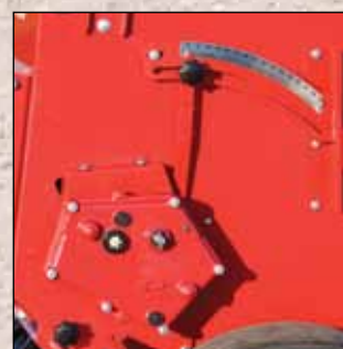
Bezpakāpju izsējas normas maiņa ar Vario-K ātrumkārbu
