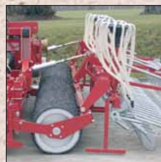
Izsējas zaru novietojums uz piespiedējruļļiem garantē vienmērīgu darba dziļumu
