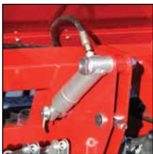
NCS 3100 hidrauliski regulējams izsējas zaru spiediens (papildaprīkojums)
