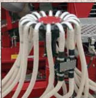
Sadales bloks ar tehnoloģiskās slīdes vārstu
