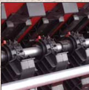
Kombinēta tipa izsējas rullīši lielām un sīkām sēklām
