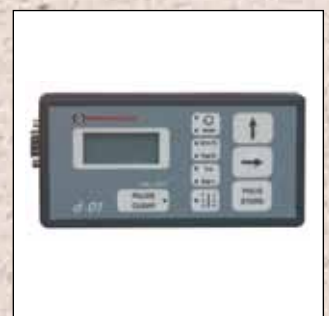
d-01 tiek lietota tehnoloģiskās slīdes regulēšanai
