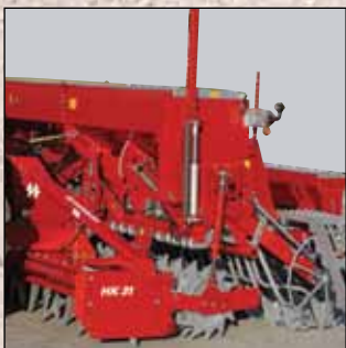
Sējmašīnas svars tiek pārvietots uz piespiedējruļli. Sējas dziļums tiek regulēts attiecībā pret piespiedējruļli
