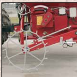
Attēlā redzama mehāniska izsējas normas regulēšana ar lauka ritenīti, iespējama arī elektriska
