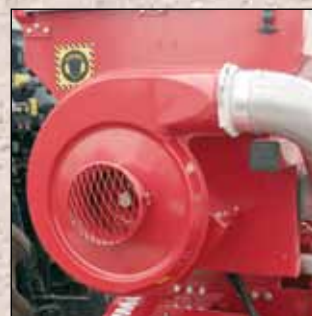
Ar jūgvārpstas piedziņu vai hidrauliski darbināms ventilators kalpo sēklu transportēšanai
