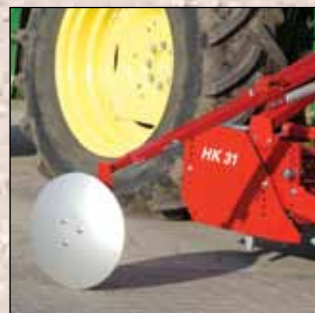
Vertikāli paceļami hidrauliski marķieri ir standarta aprīkojums
