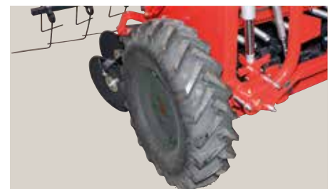
Pneu à profil agraire équipé de grattoir (option).
