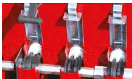
Insert pour roue à ergots (semis de petites graines).
