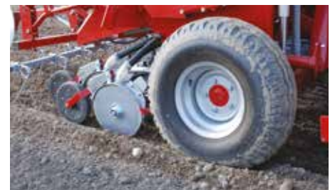
Roue large pour un entrainement de la distribution fiable.
