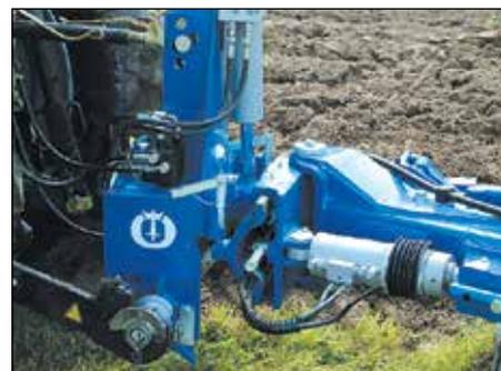
Tête d'attelage avec attelage rapide et vérin d'alignement hydraulique dessiné pour les tracteurs de fortes puissances.
