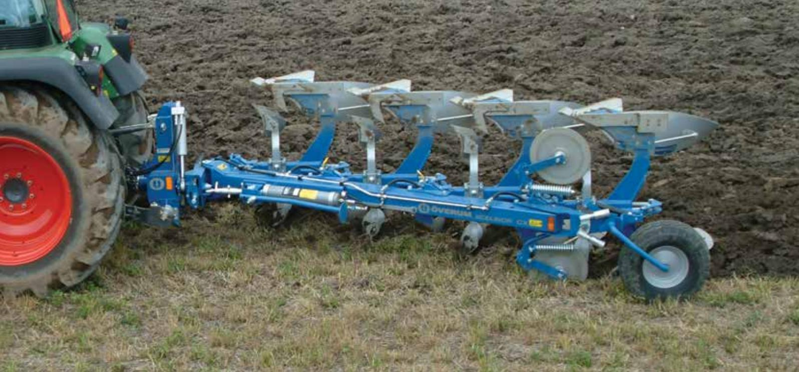
CX 4975 H avec rasettes EG. Le dégagement entre pointes de 90cm permet aux rasettes de travailler efficacement.
