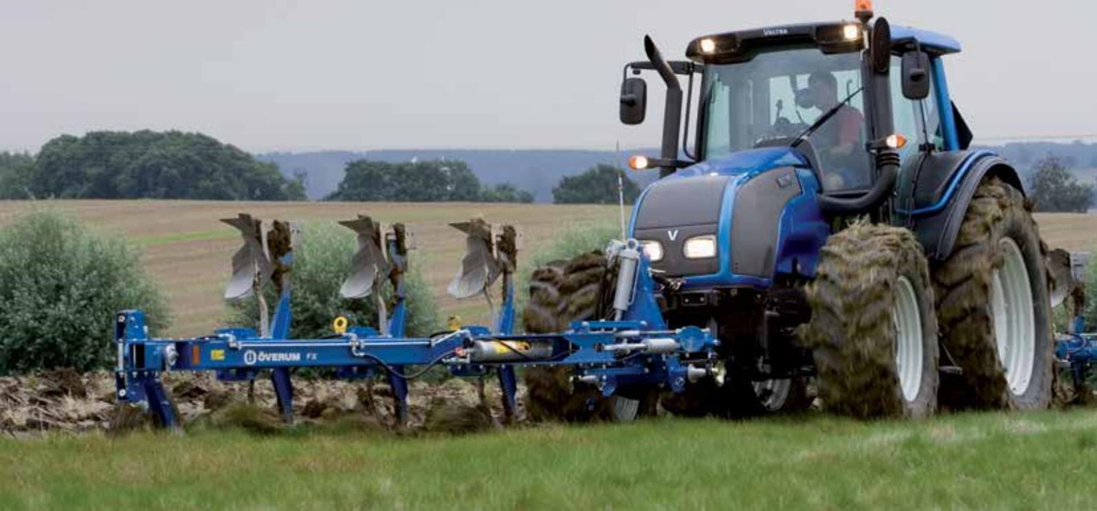
Överum Xcelsior FX 31075 H avec sécurité hydraulique et largeur de travail réglable de 16 à 18 pouces.
