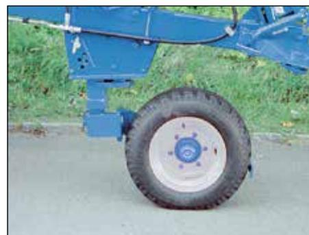
Roue combinée latérale Xcelsior DX, Diam. 755mm, largeur 275mm.
