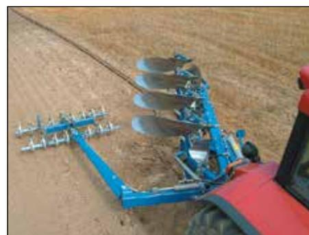
Système Nivell pour le nivellement avec charrue de 3 à 5 corps Xcelsior.
