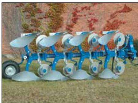
Vari Flex CX 4975 F équipé de coutres circulaires fixes et de rasette EG. Les rasettes et les corps sont équipés individuellement de boulon de sécurité.
