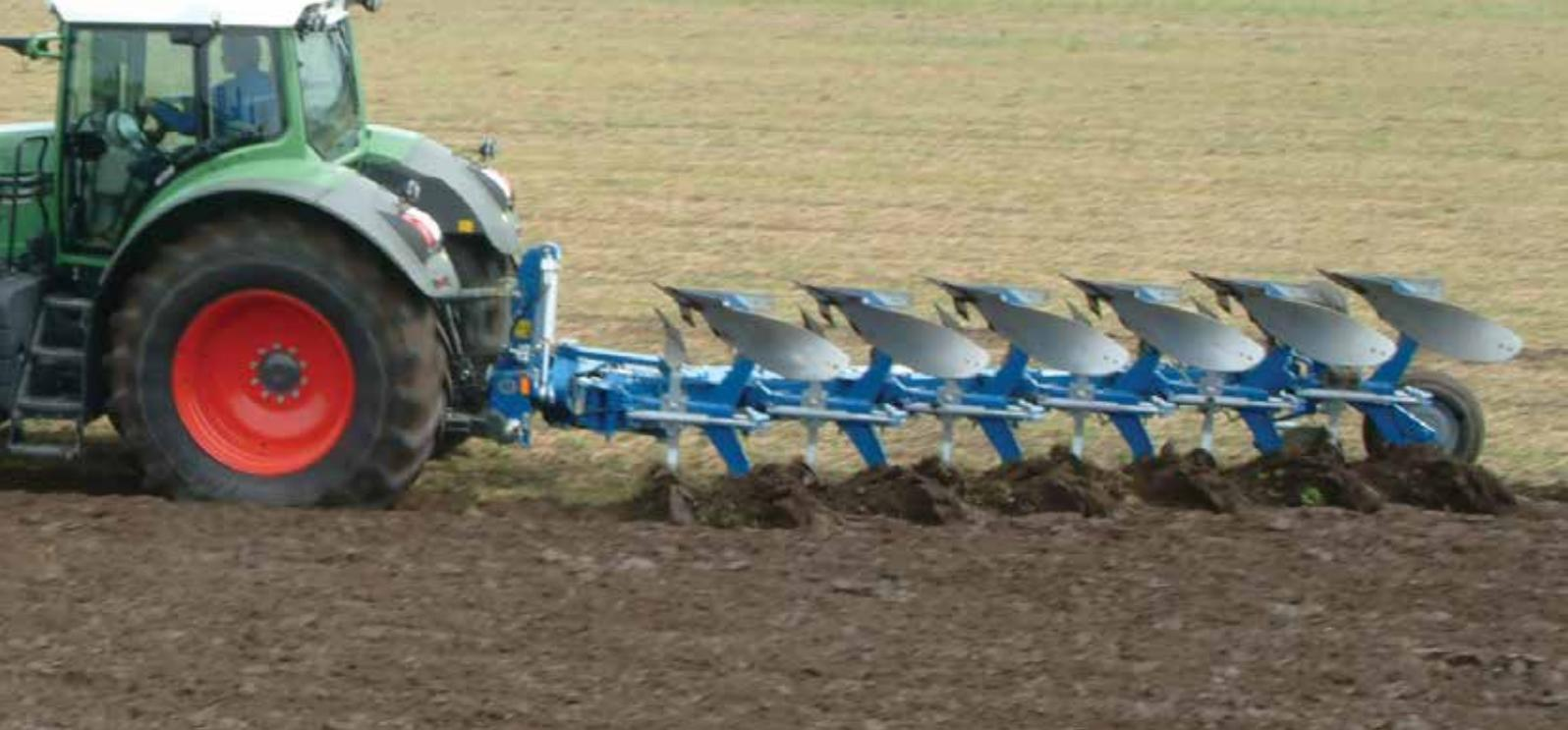
Vari Flex EX 6975 H avec réglage hydraulique de la largeur de travail jusqu'à 3.3m.
