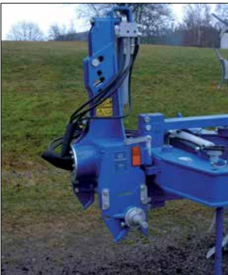
La tête de charrue Cat.3, avec une fusée de 150/180mm munie de roulements à aiguilles pour une meilleure répartition des efforts. La barre d'attelage rapide dont la hauteur et la largeur d'attelage sont variables. Verrouillage de la position transport en standard.
