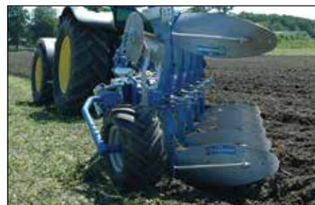
Une nouvelle roue de contrôle de profondeur offre plus de portance grâce un pneumatique plus large et plus de réglage. Lors des opérations de retournement, la roue est amortie par un système de frein à friction.
