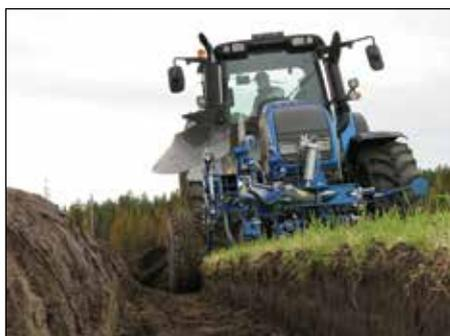
La roue avant contrôle la profondeur de travail et la direction.
