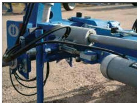
La biellette de réalignement permet un réglage précis pour réduire la puissance de traction nécessaire.
