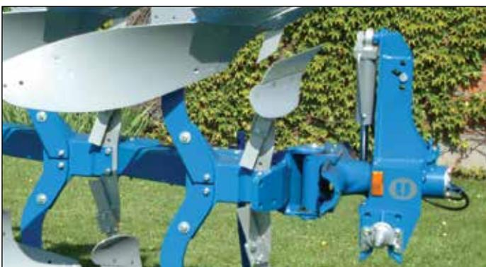
Xcelsior CX sont équipés d'une nouvelle tête de retournement avec chapes d'attelage réglables et munie d'un attelage rapide.
