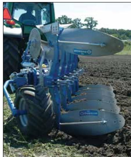
Une nouvelle roue de contrôle de profondeur offre plus de portance grâce un pneumatique plus large et plus de réglage. Lors des opérations de retournement, la roue est amortie par un système de frein à friction.
