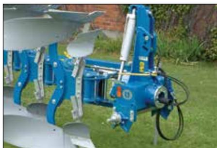
La tête de retournement Cat.3 équipé d'une fusée de 150/180mm à roulements à aiguilles pour une répartition idéale des efforts. La barre d'attelage rapide est ajustable en longueur et hauteur.
