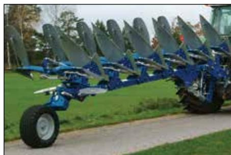
Poutre central de forte section 200x120mm sans soudure. Roue de transport/contrôle de profondeur en 260/70-16 ou 340/55-16 en option.
