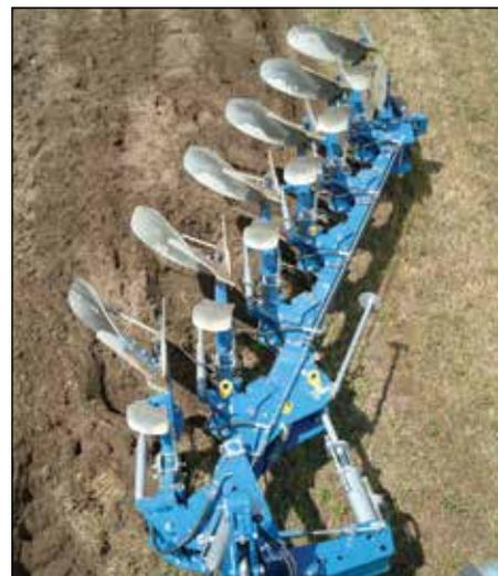
Le centre de traction est réglable avec une grande précision, il en découle une réduction de la consommation et de la puissance de traction nécessaire.
