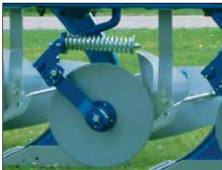
Coutre circulaire à sécurité ressorts. Diamètre 18 et 20 pouces lisse ou 20 gauffré.
