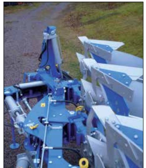
Le caisson de poutre et le double vérin sont munies de long bras de levier pour réduire l'effort. La largeur de travail est aisément réglable.
