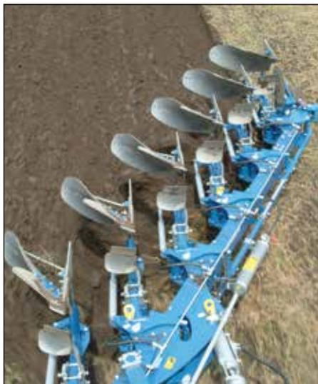
La biellette de réaligement permet un réglage précis pour afin de réduire la puissance de traction nécessaire. Poutre central de forte section (220x120mm) sans soudure. Roue de contrôle de profondeur et transport en 260/70-13 ou 340/55-16 en option.
