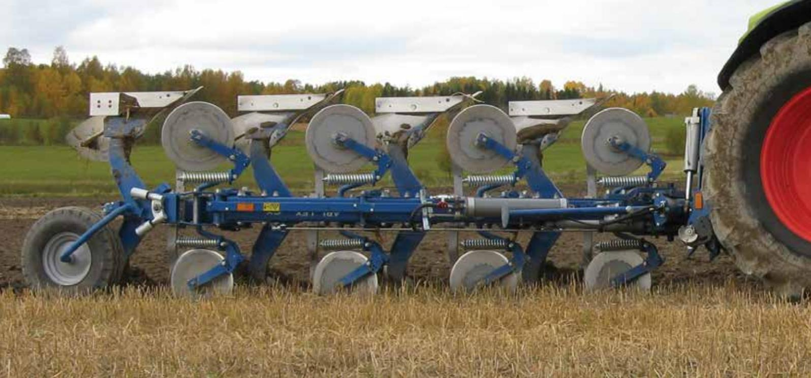
Vari Flex CX 4975 H avec réglage hydraulique de la largeur de 12 à 20 pouces.
