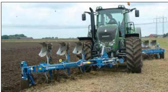
En associant une Vari Flex EX 6975H et une charrue poussée FX 31075H le débit de chantier en est que plus important avec une largeur de travail pouvant aller jusqu'à 4.5m.
