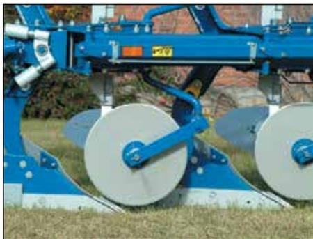
Coutre circulaire fixe. Diamètre 18 et 20 pouces lisse ou 20 gauffré.
