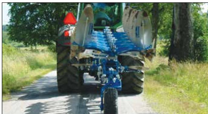
La mise en position transport se fait corps vers le haut, ceci permet de soulager l'arrière des tracteurs pour plus de sécurité.
