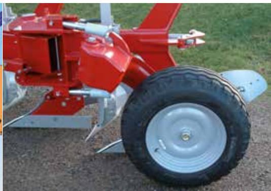
Robuste tête d'attelage cat. 3 avec fusée 150/180 mm montée sur roulements à aiguille pour résister aux charges élevées. Attelage semi-automatique réglable en hauteur et largeur. Blocage tête pour transport en position papillon.
