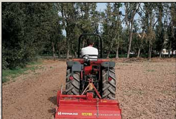
La R 300 B è equipaggiata con trasmissione a catena. Scudo mobile lungo per ottime rifiniture.
