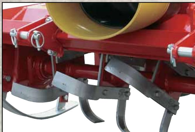
Rotor monté avec lames Rotacadet (9941/42).
