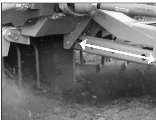
La profondità di lavoro della Stonebear è regolata per mezzo del cilindro posto sotto il timone. Se si utilizza l'attacco al sollevatore (option) la regolazione viene effettuata direttamente dal sistema di sollevamento del trattore.
