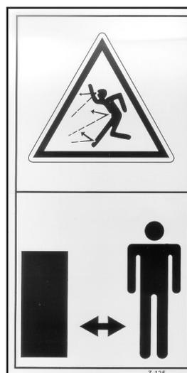
**Non sostare nel raggio d'azione della macchina.**
