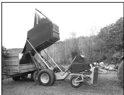
Durante il lavoro l'operatore deve continuamente monitorare il livello del cassone. Quando il serbatoio della Stonebear è pieno, i denti del tamburo di raccolta non sono più in grado di caricare le pietre ma le convogliano nuovamente in fronte alla macchina. E' necessario fermare immediatamente la trasmissione e svuotare il cassone.
