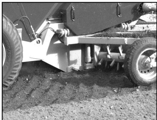
In funzione della tipologia e quantità delle pietre e del terreno la velocità deve essere da 0 - 6 km/h. Se operiamo con elevato quantitativo di pietre aventi 15 - 30 cm la velocità deve essere minima (0 - 2 km/h). in terreni con pietre medie 4 - 10 cm, la velocità può essere da 3-6 km/h. Il lavoro deve comunque sempre iniziato ad una adeguata bassissima velocità.
