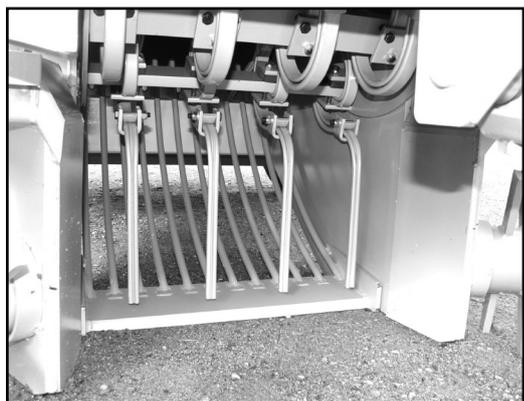
Il crivello da 40 mm è fornito come standard nella Stonebear, poichè adattabile alla maggior parte delle condizioni del terreno. Quando si richiede una raccolta grossolana con rilascio di zolle si può usare quello da 50 mm. Le spaziature da 28 o 35 mm sono utilizzate su campi da patate, nella manutenzione dei parchi e nella costruzione delle strade.
