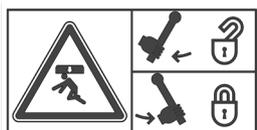
Cuando las secciones del lateral están levantadas en la posición de transporte, los laterales siempre tienen que ir protegidos mediante bloqueos mecánicos de transporte.
