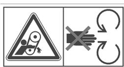
**Durante los trabajos de mantenimiento puede existir riesgo de aplastamiento de las manos. Asegúrese de que todas las pantallas están puestas en su sitio correctamente después de terminar los trabajos de mantenimiento.**
