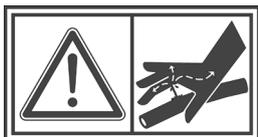
Proceda con suma cautela en las inmediaciones de fugas hidráulicas o mangueras dañadas. El fluido hidráulico bajo presión puede ser extremadamente peligroso. Siempre libere la presión del sistema antes de aflojar cualquier tubo, unión o manguera hidráulica. Acuérdesse de apretar todas las conexiones antes de poner el sistema bajo presión. Use las protecciones para las manos y ojos.
