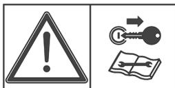
**Apague el motor y retire la llave antes de realizar el mantenimiento, trabajos de reparación y/o antes de demontar las protecciones de seguridad.**
