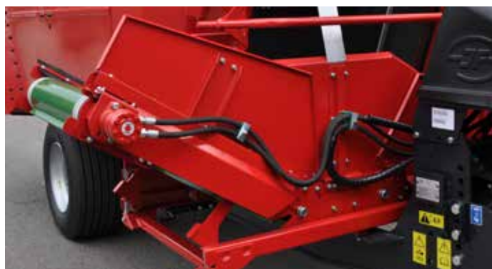
Seria X - elastyczne rozwiązanie 4 w 1 z poprzecznym przenośnikiem transportowym (mieszanie - przesuw boczny - elewator na prawo i lewo) - VM-SB X i VM-B X.
