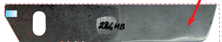
Stal drobnoziarnista (S650) po teście ścierania.
