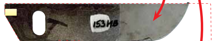
Stal jakościowa (S355) po teście ścierania.
