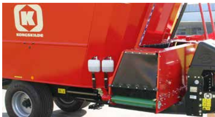
Seria B do profesjonalnego wysypu z przednim przenośnikiem transportowym VM-SB i VM-B, i opcjonalnie elewateorem bocznym.
