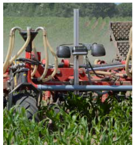
Höhe und Winkel der Stereokamera können dem Wachstumsstadium der Kultur angepasst werden.
