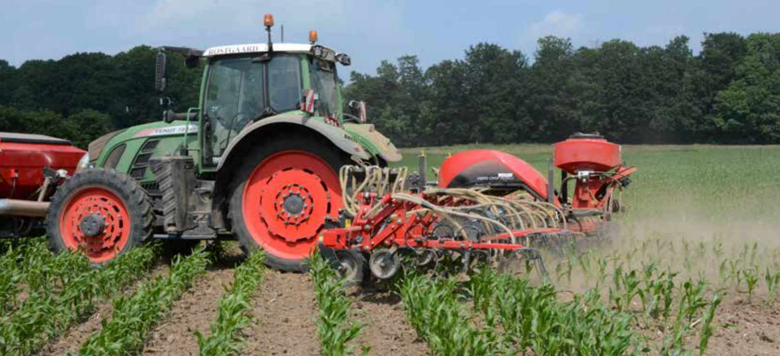
VCO-I mit Sektionskontrolle – die äußere Sektion auf der linken Seite ist angehoben.
