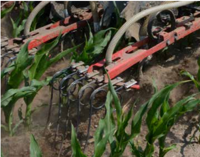
Der einfach aufgebaute robuste Saatstriegel schützt die Verteilerplatten des Feinsaatkastens.
