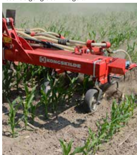
Die Kamerasteuerung ermöglicht eine höhere Geschwindigkeit und damit auch eine höhere Kapazität.
