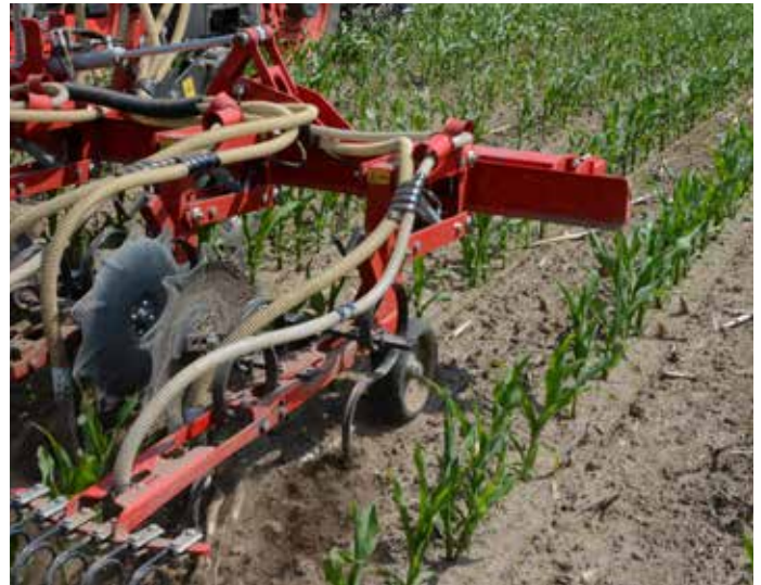
Reinigungssektionen mit echten Zinken und Scharen von Kongskilde sowie rotierenden Pflanzenschutzschilden für eine optimale Bearbeitung.
