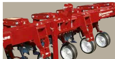
Les chapes d'attelage peuvent être réglées de façon indépendante sur la poutre principale
