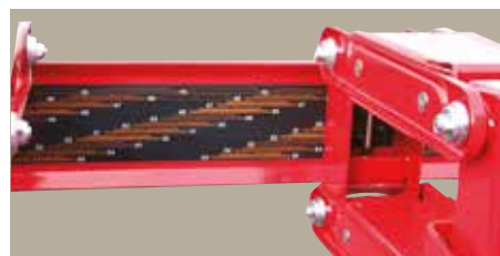
Position des éléments pré-marquée sur la poutre.
