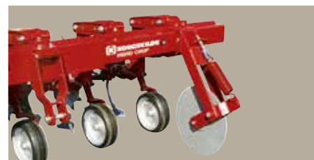
Disque stabilisateur équipé d'une sécurité ressort.
