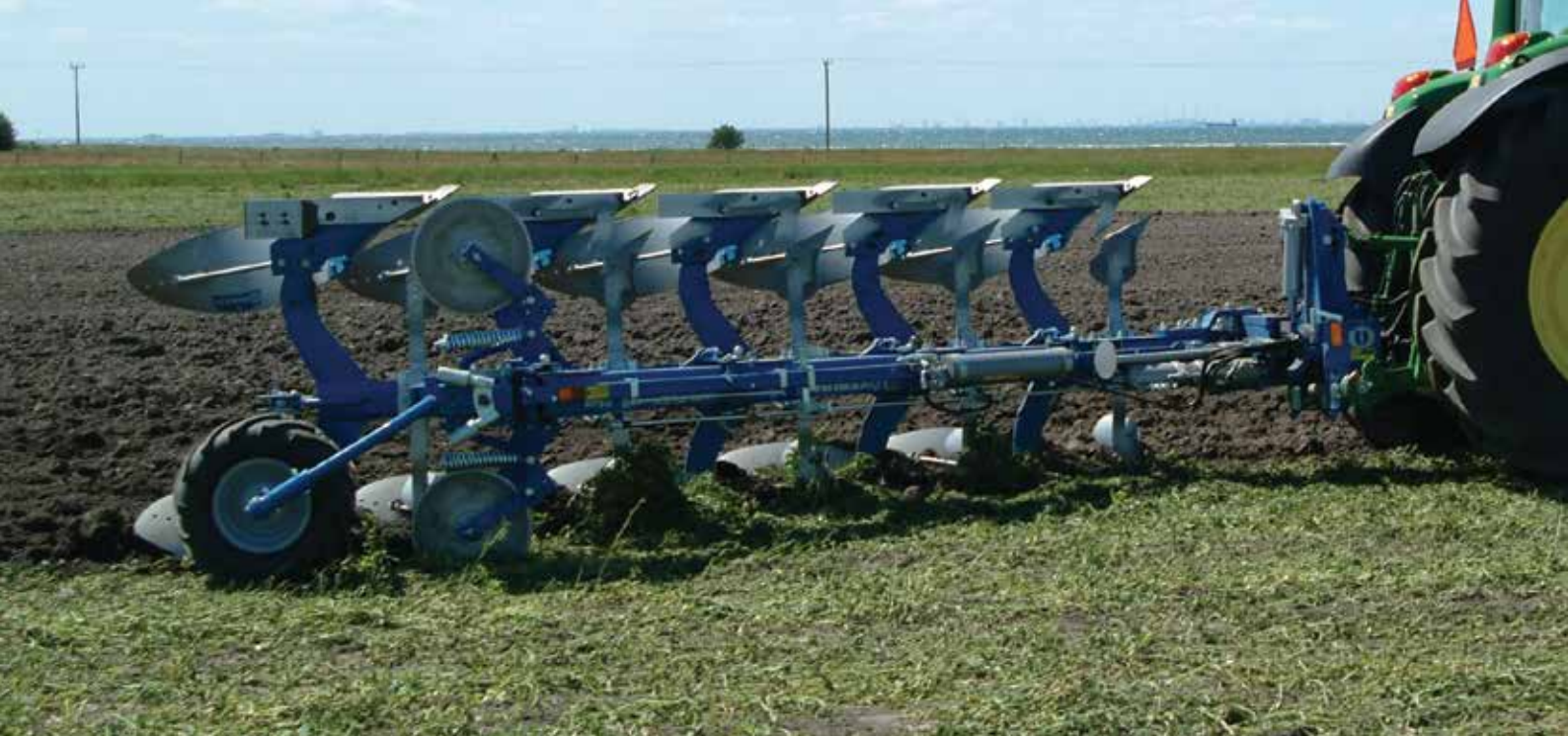
Vari Flex CX Plus 5975 H. Ketterä 5-teräinen keskiluokassa, 200 hv:n teholuokkaan saakka.
