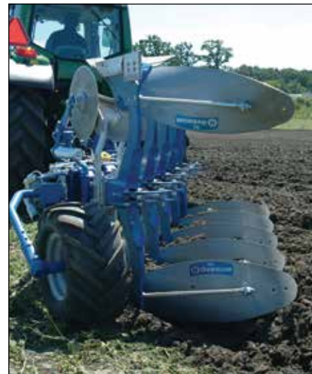
Uusi, vahvarakenteinen tukipyörä suuremmalla säätöalueella. Kääntöliikettä rajoittaa säädettävä kitkajarru. Leveän renkaan kantavuus on erityisen hyvä.
