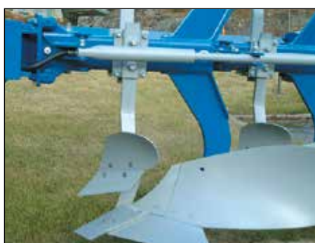
EG-esiaura. Leveä, matala kuorinta. Toimii hyvin sekä veitsi- että kiekkoileikkurin kanssa.
