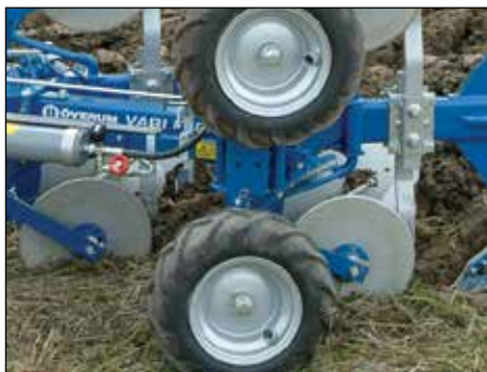
Kaksoistukipyörä runkoon kiinnitettynä. Halkaisija 572 mm, leveys 210 mm.
