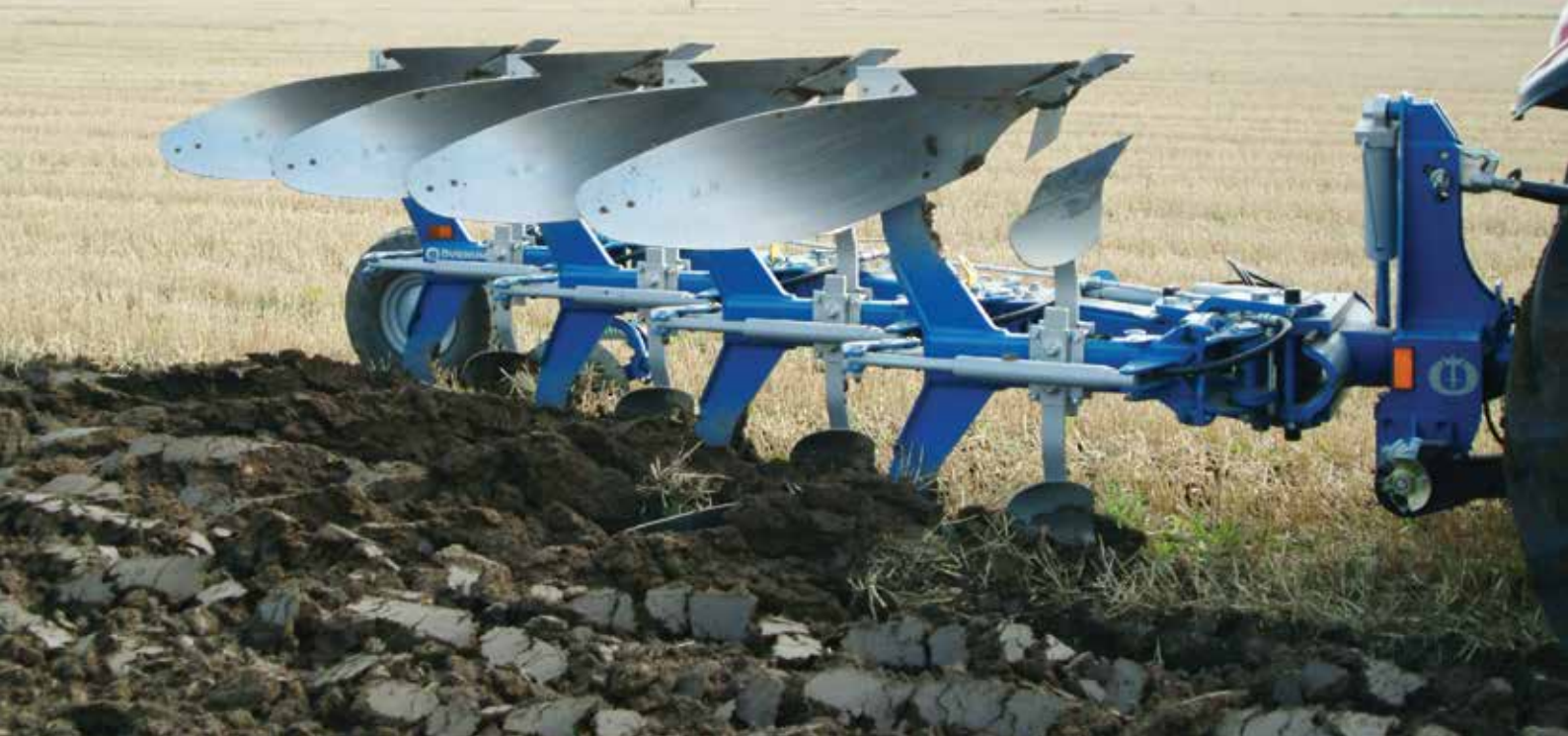
Vari Flex CX 4975 H veitsileikkureilla ja EG-esiauroilla. Hydraulisesti säädettävä työleveys 1,2-2 m.
