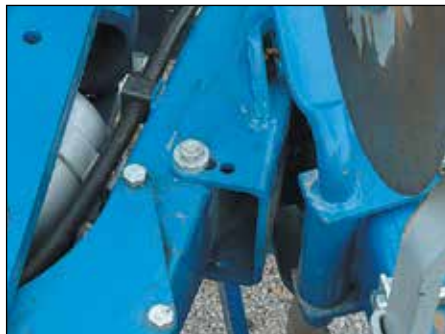
Viulun leveys voidaan säätää kolmeen eri leveyteen.
