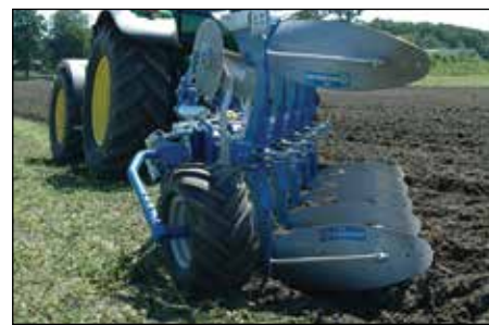
Uusi, vahvarakenteinen tukipyörä suuremmalla säätöalueella. Kääntöliikettä rajoittaa säädettävä kitkajarru. Leveän renkaan kantavuus on erityisen hyvä.
