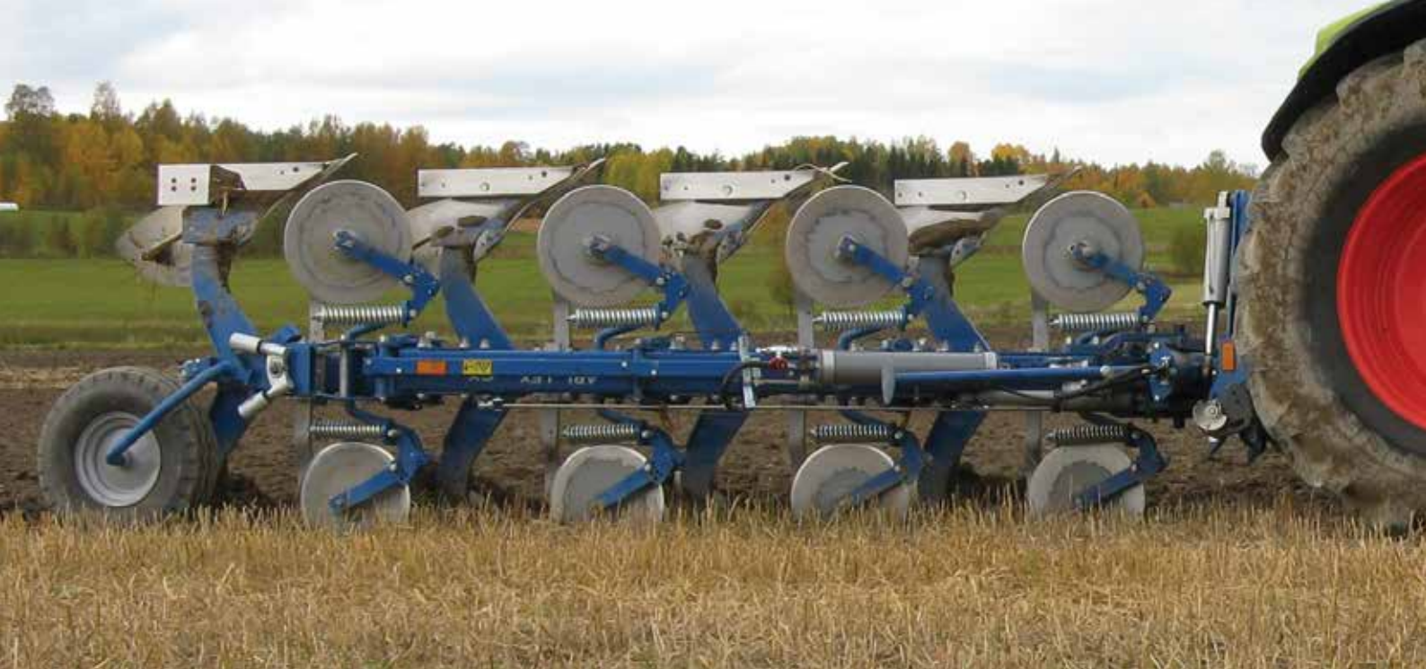
Vari Flex CX 4975 H jousitetuilla kiekkeleikkureilla ja EG-esiauroilla. Hydraulinen viulun leveyden säätö 12-20 tuumaa.
