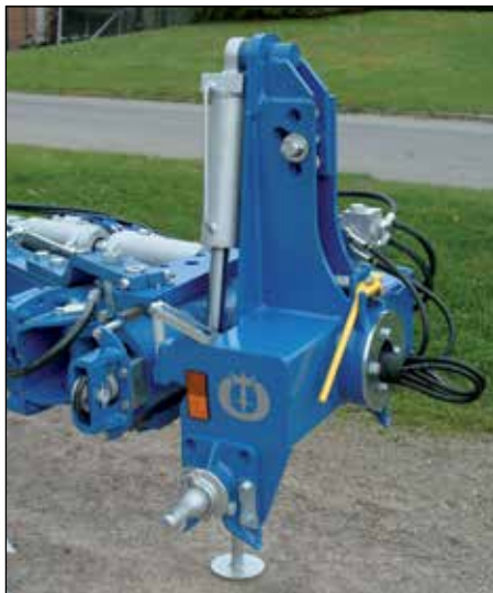
Vankrakenteinen, kokoluokan 3 kääntöpää rullalaakeroituine 150 mm:n kääntöakseleineen on mitoitettu jopa 200 hv traktoreille.
