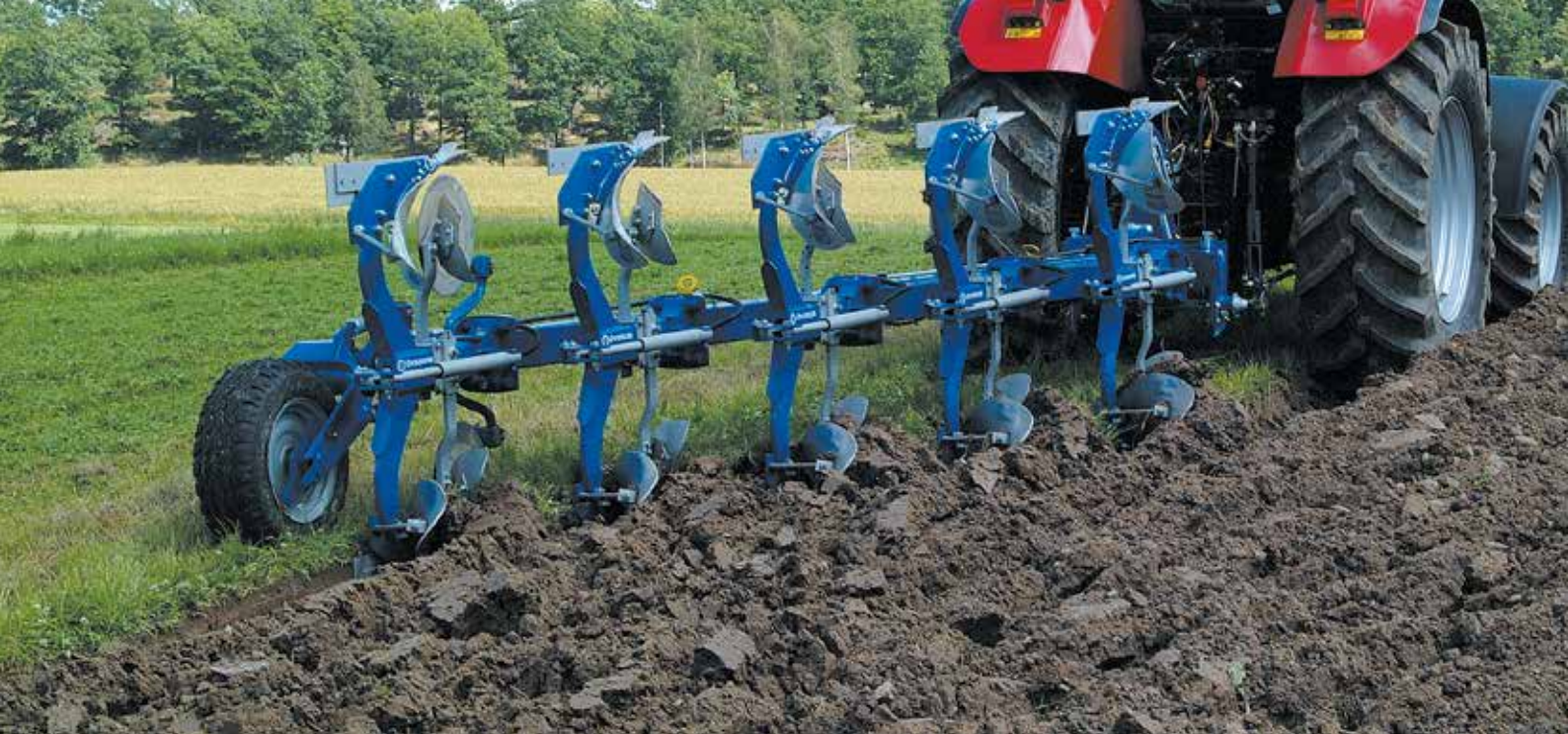
Xcelior DX 5975 H EG-esiauroilla. Vankkarakenteinen aura raskaisiin kyntöolosuhteisiin.
