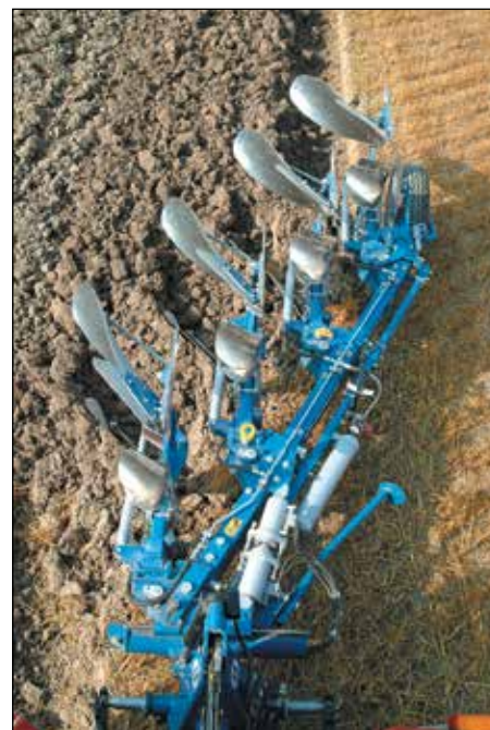
Tarkkuusporatut pulttiliitokset mahdollistavat karkaistun teräksen käytön rungossa.
