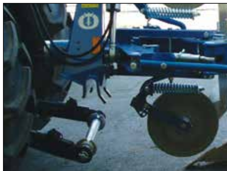
Vetokartun pikakiinnitys helpottaa kytkentää.
