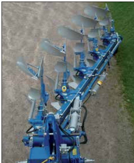
Viulun leveyssäädön niveltä onnistuneen geometrian ansiosta säätö voidaan tehdä vähemmällä voimalla kulumisen ollessa pientä.
