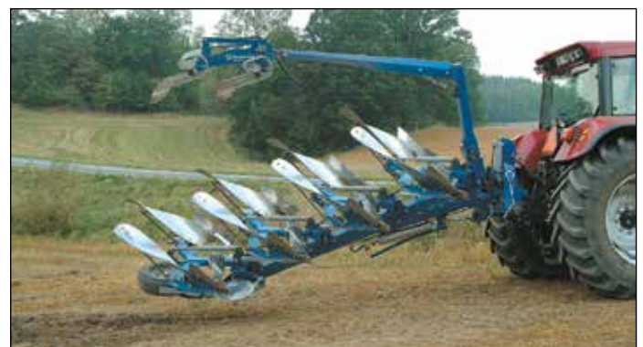
Yläkautta tapahtuva kääntäminen vaatii hieman enemmän nostotehoa. Alakautta tapahtuvan kääntämisen (kts. sivu 3) nostotehon tarve ei ole yhtä suuri.
