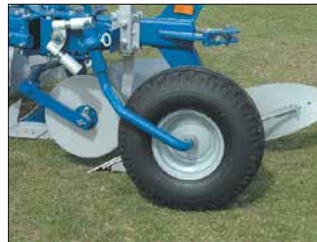
Syvyyden säädön/kuljetuksen kombipyörä. Koko 10,00x12. Halkaisija 710 mm, leveys 264 mm.
