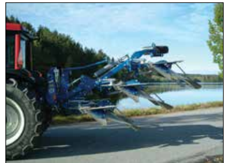
Alakautta tapahtuvan käynnön ansiosta painopiste on lähellä traktoria ja aura on kevyt nostaa.
