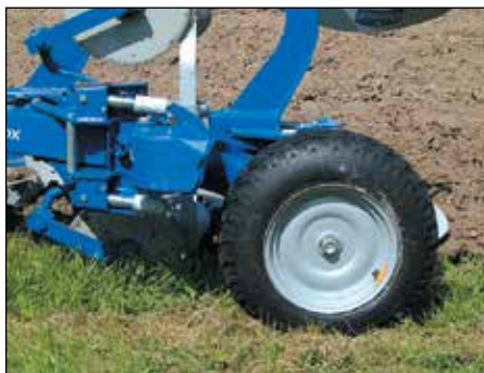
Xcelsior / Vari Flex DX kombipyörä. Koko 10,5x16. Halkaisija 755 mm, leveys 275 mm.
