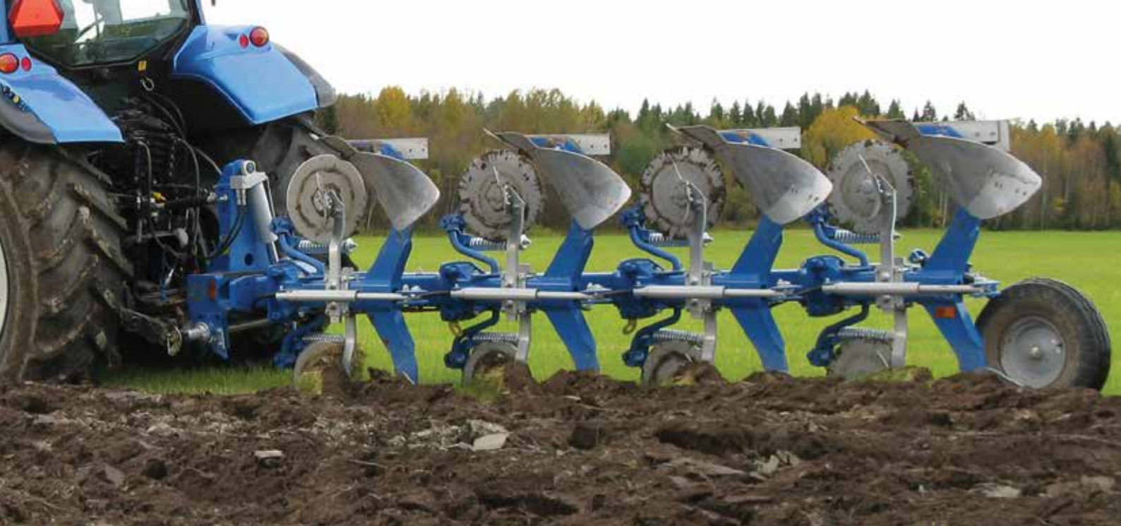
Xcelior CX 4975 H varustettuna kiekkeleikkureilla ja EG-esiauroilla. Työleveyden käsisäätö 140-180 cm.
