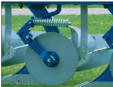
Jousitettu 18" tai 20" sileä tai 20" hammas- tettu kiekkeleikkuri.
