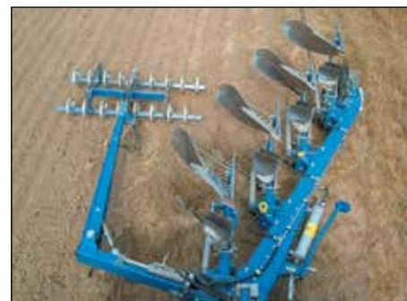
Rungon leveys kasvaa eteenpäin kuormituksen kasvaessa. Viulun leveyden säätö on kolmiportainen.
