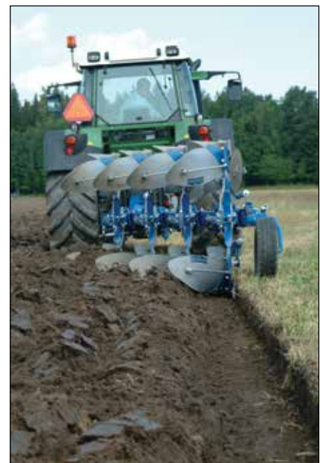
CX 4975 H, XL-siipi ja EG-esiaura mahdollistavat hyvän kyntötuloksen.
