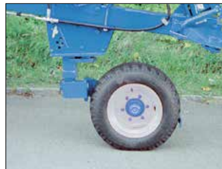
Runkoon kiinnitetty kombipyörä Xcelsior DX -malleihin. Rengaskoko 260/70-16.
