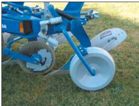
Teräsinen tukipyörä. Halkaisija 500 mm, leveys 160 mm.
