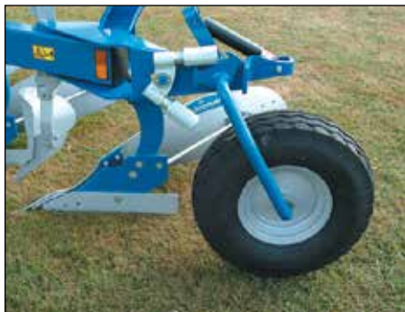
Kuminen tukipyörä 7,00x12. Halkaisija 645 mm, leveys 182 mm.
