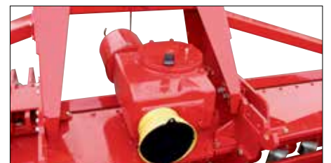
Kolminopeuksinen, vipukäyttöinen, -takavoimanotolla varustettu vaihdelaatikko.
