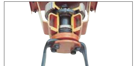
Roottori ja vaihdettava kotelo.
