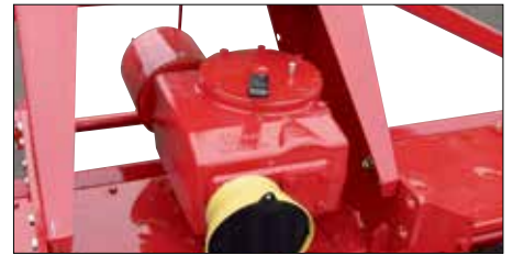
Kolminopeuksinen, vipukäyttöinen, -takavoimanotolla varustettu vaihdelaatikko.
