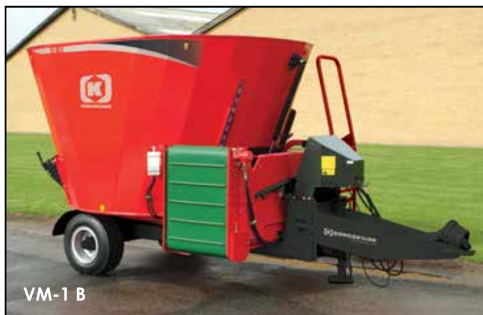
VM-1 B X 4-yhdessä ratkaisu (vaakasuora – sivun vaihto – purku vasemmalle ja oikealle).
