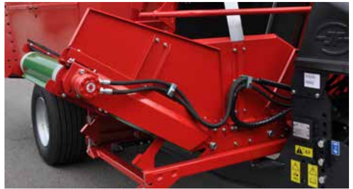
X-mallisarja – monipuolinen 4-yhdessä poikittaiskuljetin (vaakasuora – puolen vaihto – purku vasemmalle ja oikealle) – VM-SB X ja VM-B X.
