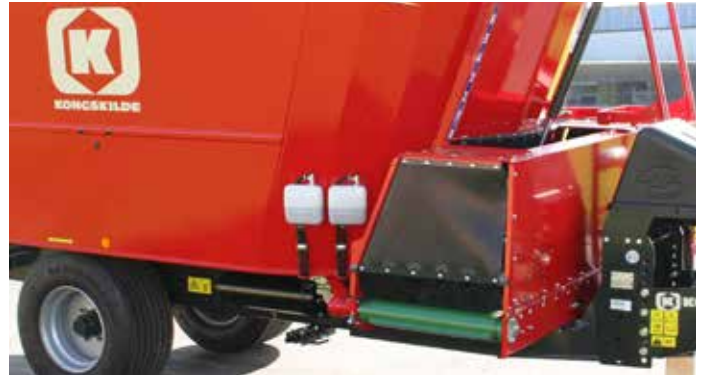
B-mallisarja ammattimaiseen rehun jakoon edessä olevalla pikittaiskuljettimella – VM-SB ja VM-B, sivuelevaattori lisävarusteena.
