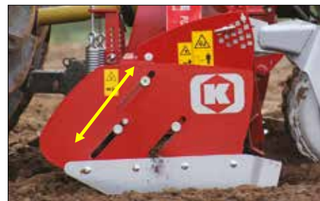
El deflector lateral puede moverse desde la parte delantera hasta la parte trasera.
