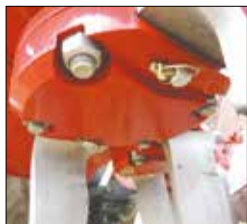
Pasador Rubig integrado en la brida del rotor inferior.
