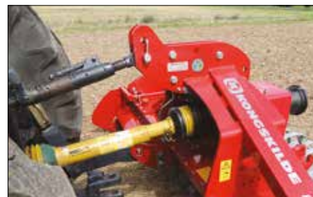
Tercer punto con refuerzo integrado.
