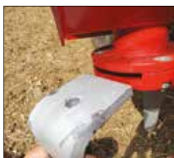
Sustitución de la cuchilla.
