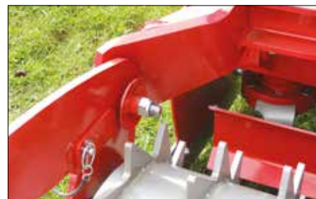
Acoplamiento rápido del módulo de unidad de siembra en el rodillo trasero.
