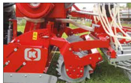
Geometría de paralelogramo para el acoplamiento de la sección de siembra. No se requiere realizar el ajuste de la posición de la sección de siembra al cambiar la profundidad de trabajo.
