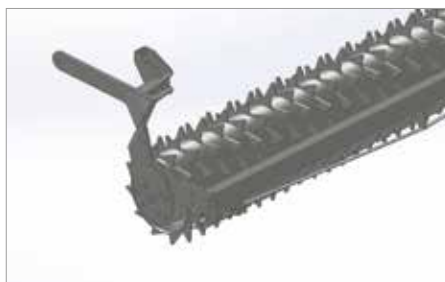
Rodillo compactador con dientes.
