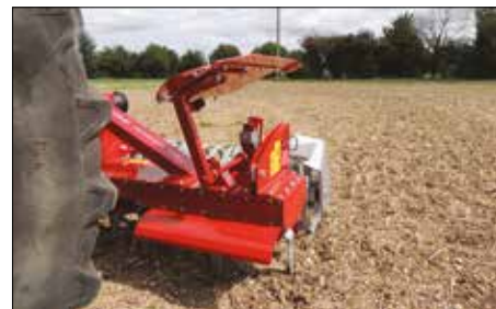
Deflector lateral en posición de transporte por carretera.
