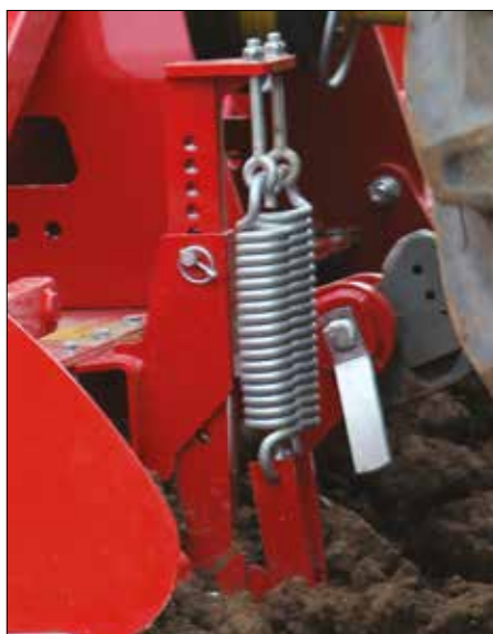
Eliminador de huellas con doble resorte.
