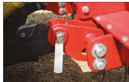
Soporte inferior flotante.
