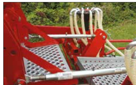
Conexión superior entre la sección de siembra y la tolva con barra de tiro superior, lo que permite ajustar el nivel de la barra de siembra.
