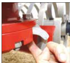
Retirada del pasador de retención que fija la cuchilla.
