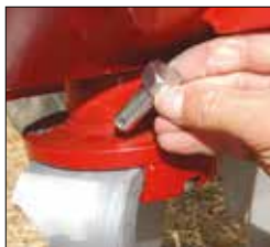
Pasador con cabeza semi hexagonal que no puede girar.
