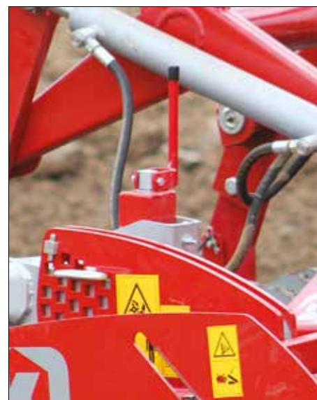
Ajuste de altura mediante husillo y suspendido sobre amortiguador de goma.
