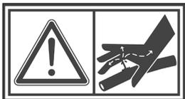
**Никогда не пробуйте отсоединить какое-либо гидравлическое соединение, если система находится под давлением.**
